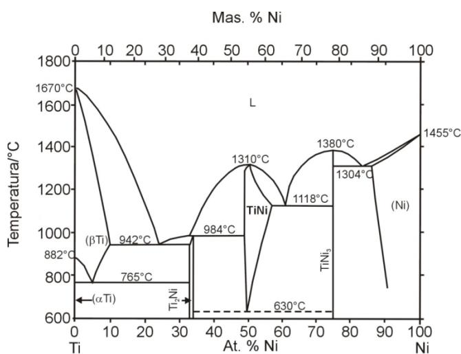
Slika 10. Fazni dijagram NiTi slitine s prisjetljivosti oblika [3]
