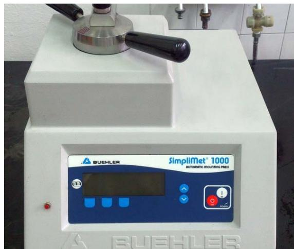
Slika 14. Uredaj SimpliMet 1000 za toplo „prešanje“ uzorka (metalografska priprema)
