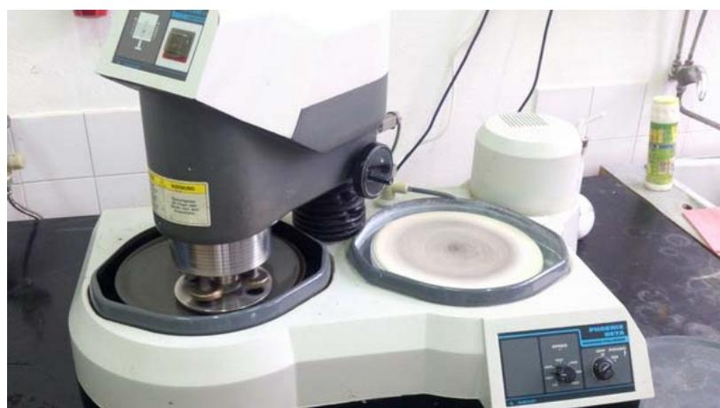
Slika 15. Uredaj PHOENIX BETA za brušenje i poliranje uzorka
