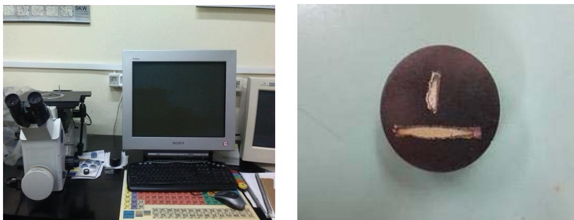
Slika 16. Fotografija optičkog mikroskopa OLYMPUS GX 51 (a) i pripremljenog uzorka (b)
