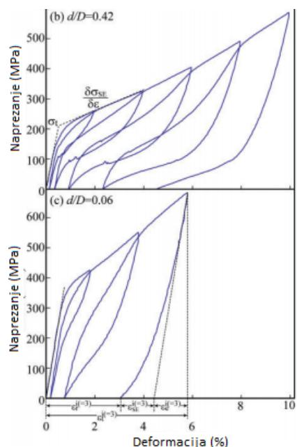
Slika 11. Krivulje naprezanje - deformacija dobivene od uzoraka žice s različitim  $d/D$  [14]
