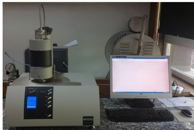
Slika 18. Uređaj za DSC toplinsku analizu – Laboratorij za razvoj i primjenu materijala
