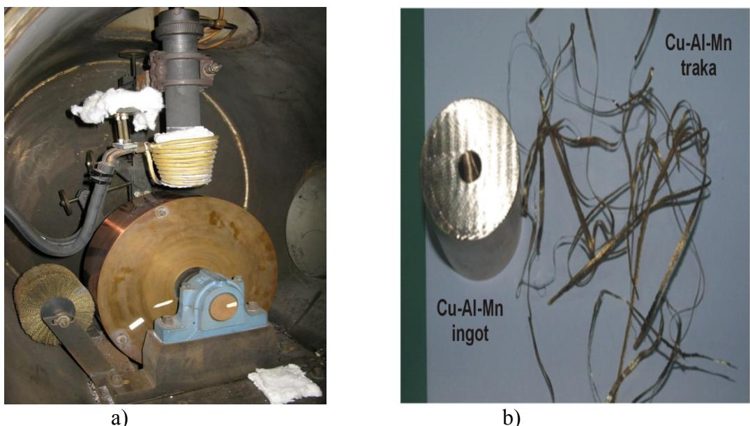
Slika 13. Fotografija „melt-spinnera“ (a) te CuAlMn ingota i brzo očvrstnute trake (b)
