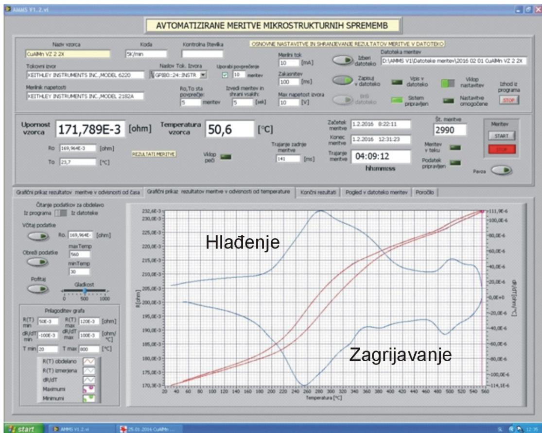
Slika 25. Ovisnosti električnog otpora o temperaturi brzo skrnutnih CuAlMn traka
