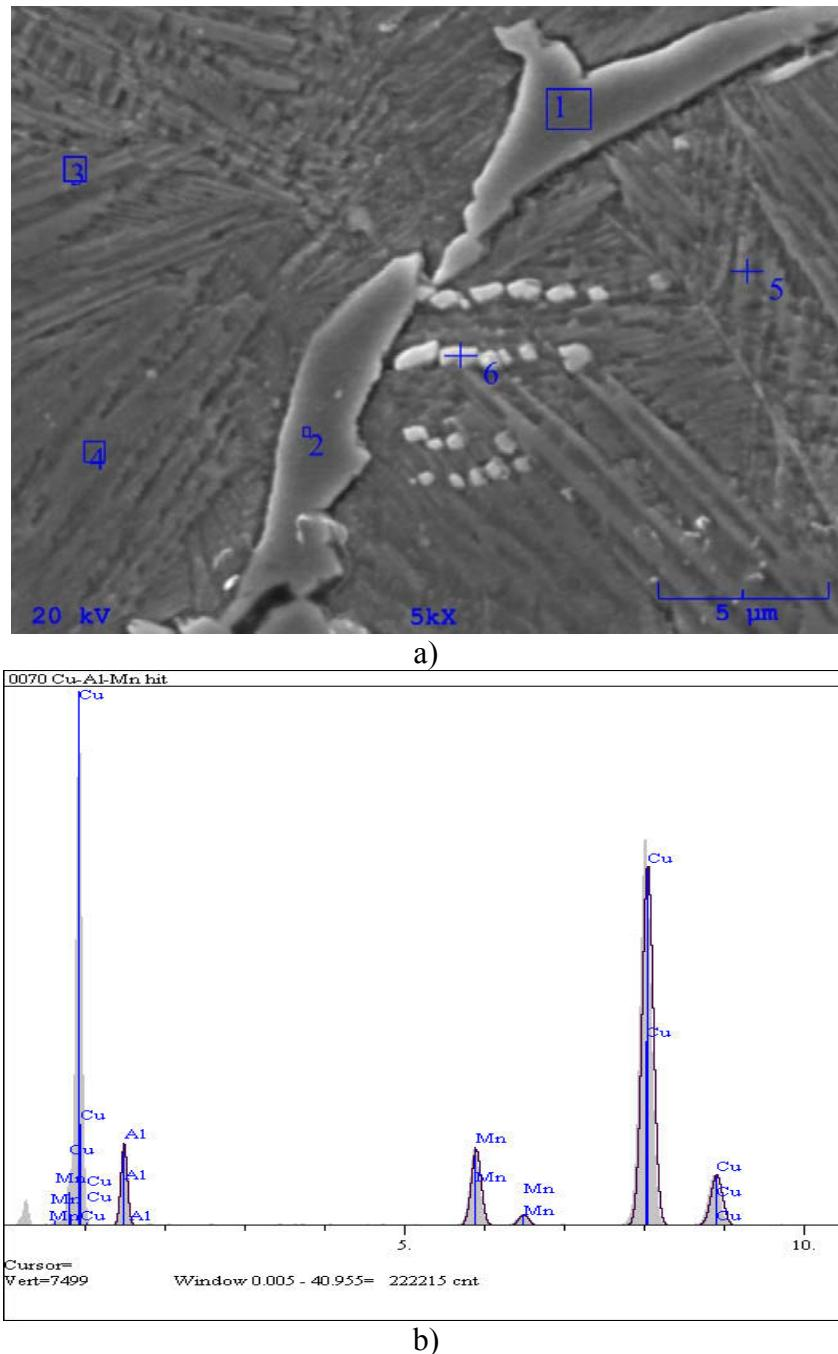
Slika 23. SEM mikrografija (a) i energetsko disperzijski spektar – pozicija 1 (b) CuAlMn brzo skrunutne trake poslije lijevanja „melt spinning“ postupkom – pozicija 1, povećanje 5000x
