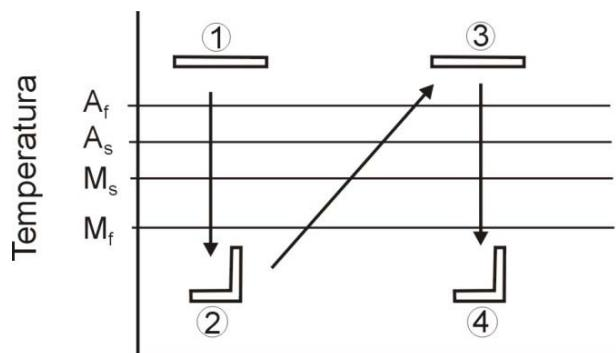
Slika 5. Shematski prikaz dvosmjernog efekta prisjetljivosti oblika [3]
