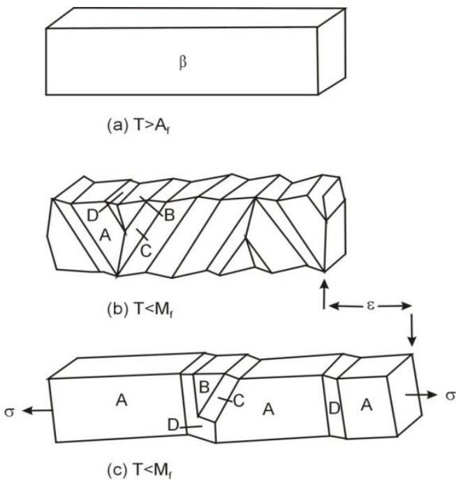
Slika 3. Shematski prikaz kristala  $\beta$ -faze (a), spontano nastali martenzit, sraslaci varijanti A, B, C i D nakon hlađenja i transformacije u martenzit (b), varijanta A je dominantna nakon podvrgavanja naprezanju (c) [3]
