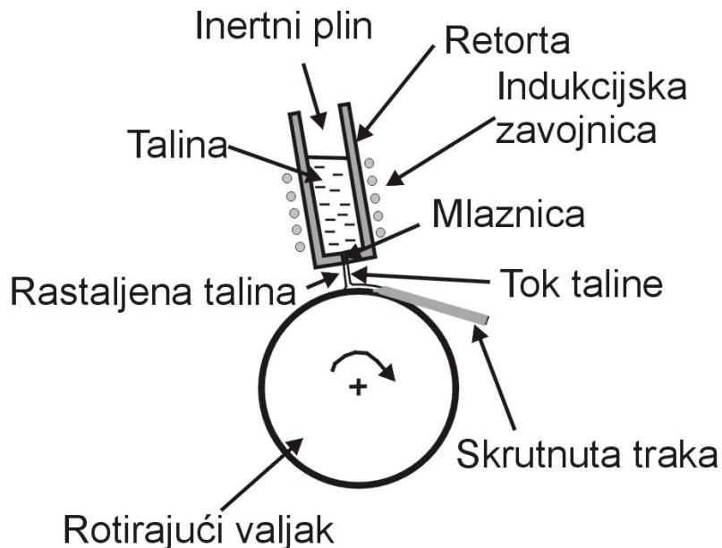
Slika 12. Shematski prikaz „Free melt Jet Spinner“ postupka [15]
