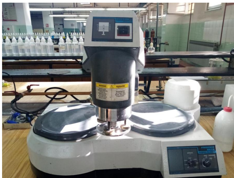
Slika 21. Automatski uređaj za brušenje i poliranje (Büehler)
