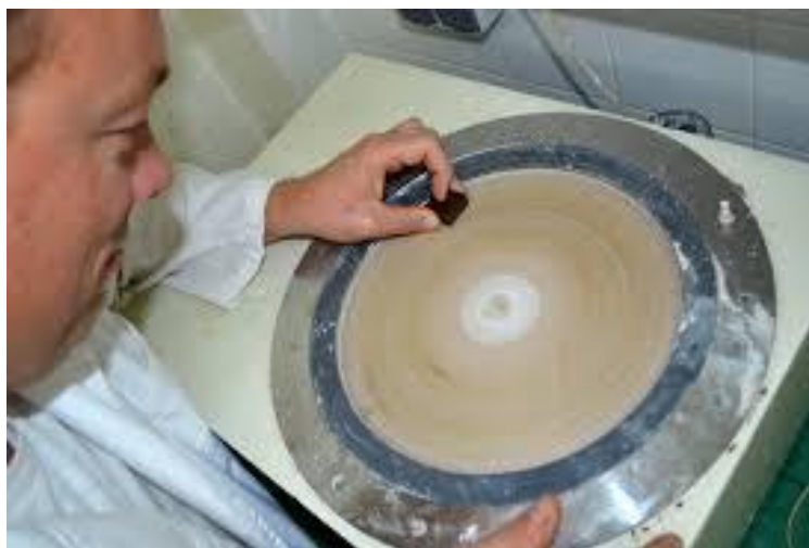
Slika 16. Poliranje površine metala [25]
