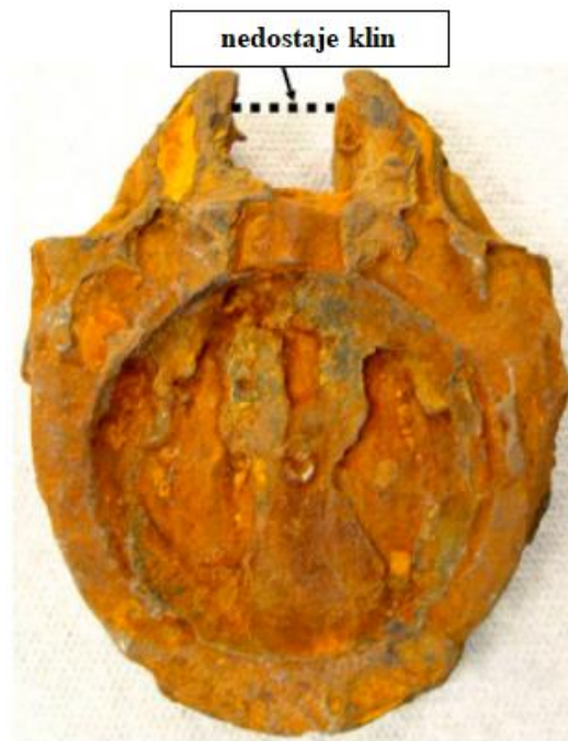
Slika 3. Opća korozija zasuna [8]
