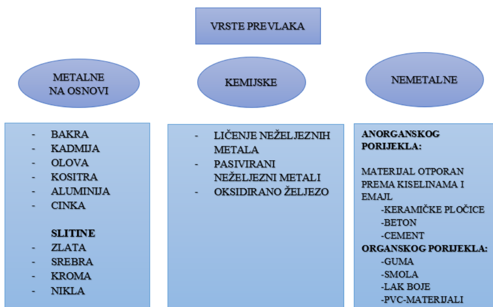
Slika 14. Shematski prikaz podjele prevlaka za površinsku obradu
