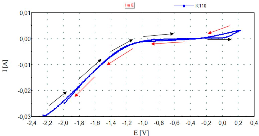
Slika 26. Ciklički voltamogram uzorka K110 u mediju 3,5 % NaCl
