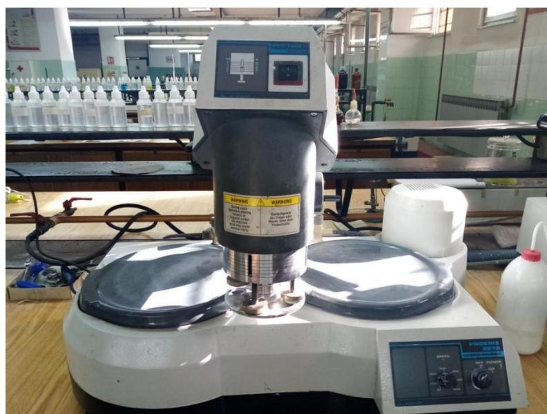
Slika 21. Automatski uređaj za brušenje i poliranje (Büehler)
