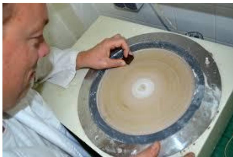
Slika 16. Poliranje površine metala [25]
