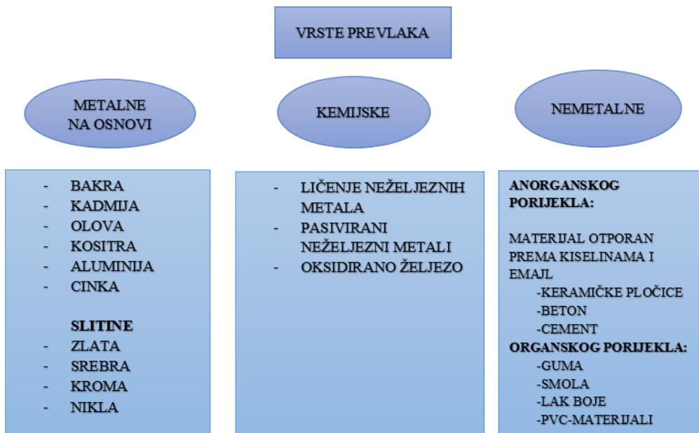
Slika 14. Shematski prikaz podjele prevlaka za površinsku obradu
