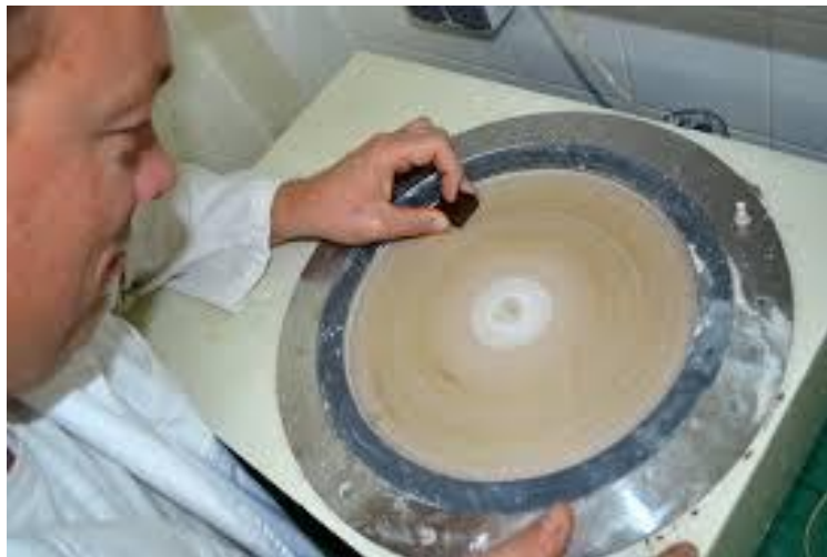
Slika 16. Poliranje površine metala [25]
