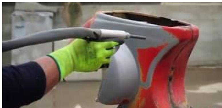
Slika 17. Uklanjanje nečistoća mlazom abraziva [26]
