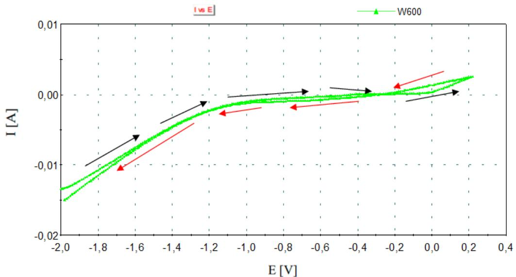
Slika 27. Ciklički voltamogram uzorka W600 u mediju 3,5 % NaCl
