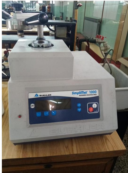
Slika 20. Uređaj za ulaganje uzoraka u ugljičnu masu postupkom vrućeg prešanja, (SimpliMet® 1000)
