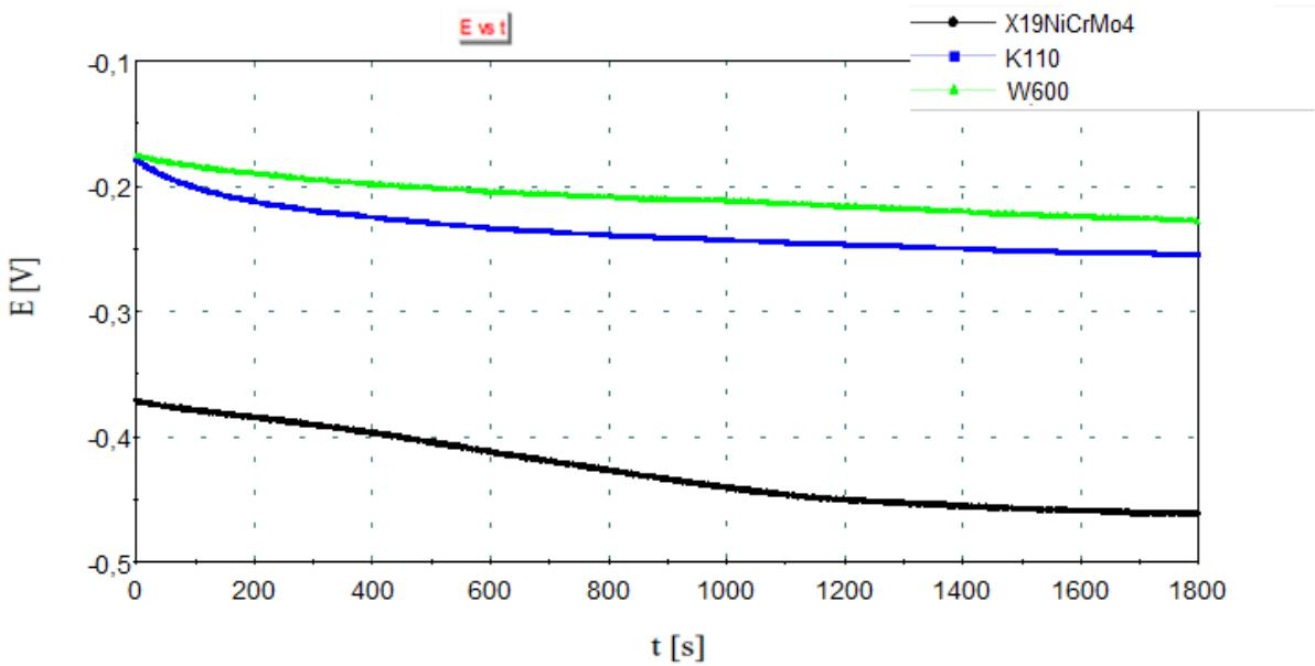
Slika 24. Komparativni dijagram ovisnosti mirujućeg potencijala o vremenu za ispitane alatne čelike u mediju 3,5 % NaCl
