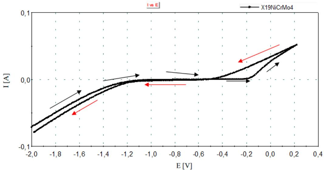
Slika 25. Ciklički voltamogram uzorka X19NiCrMo4 u mediju 3,5 % NaCl
