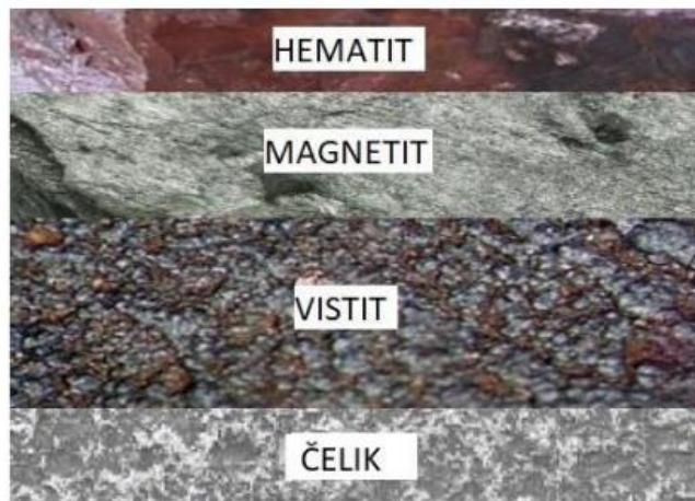
Slika 1. Oksidni slojevi na površini čelika [3]
