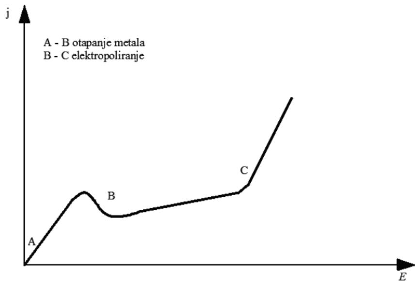
Slika 19. Krivulja anodne polarizacije pri elektropoliranju metala [1]
