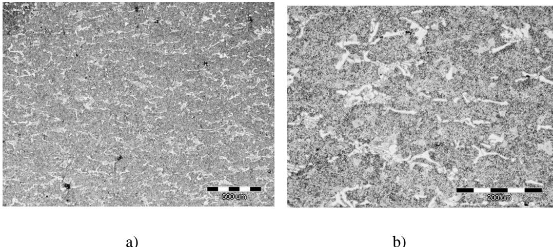
Slika 28. Mikrostruktura alatnog čelika za hladni rad K110 nakon nagrizanja u nitalu:
