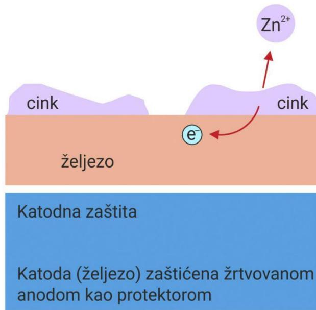
Slika 11. Zaštita žrtvovanom elektrodom - protektorom [15]
