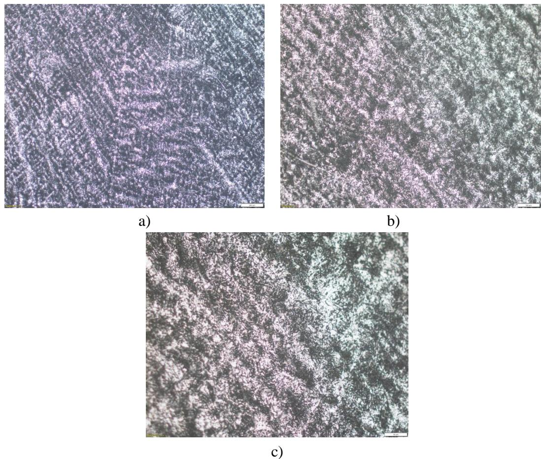
Slika 33. Metalografski snimak alatnog čelika X19NiCrMo4 poslije elektrokemijskih ispitivanja u mediju 3,5 % NaCl:
