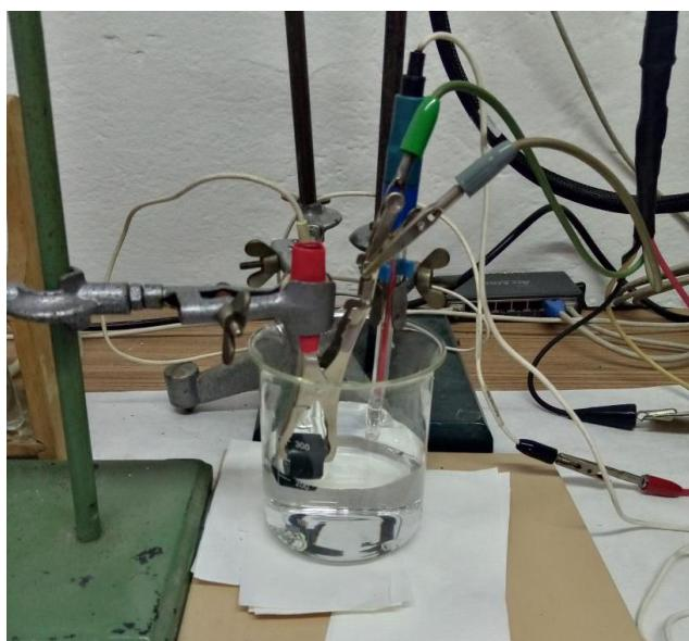
Slika 22. Troelektrodna staklena ćelija za elektrokemijska ispitivanja
