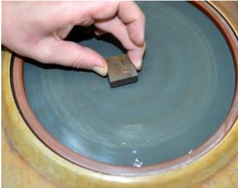
Slika 15. Priprema površine brušenjem [24]
