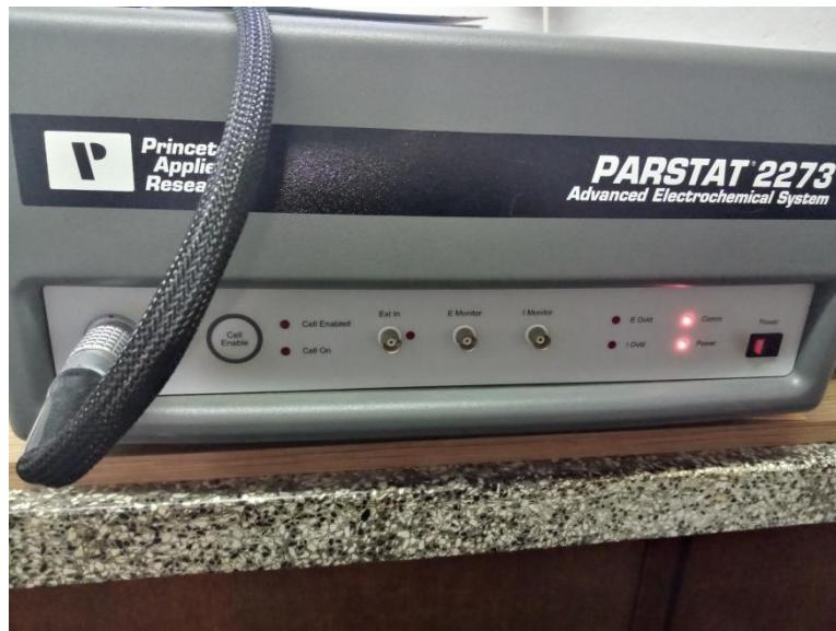
Slika 23. Potenciostat/galvanostat (Parstat 2273)
