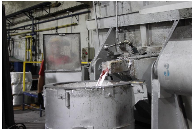
Slika 43. Lijevanje taline u transportni lonac
