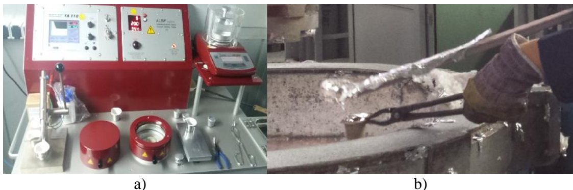
Slika 45. Ispitivanje indeksa gustoće i toplinska analiza uzorka taline:
