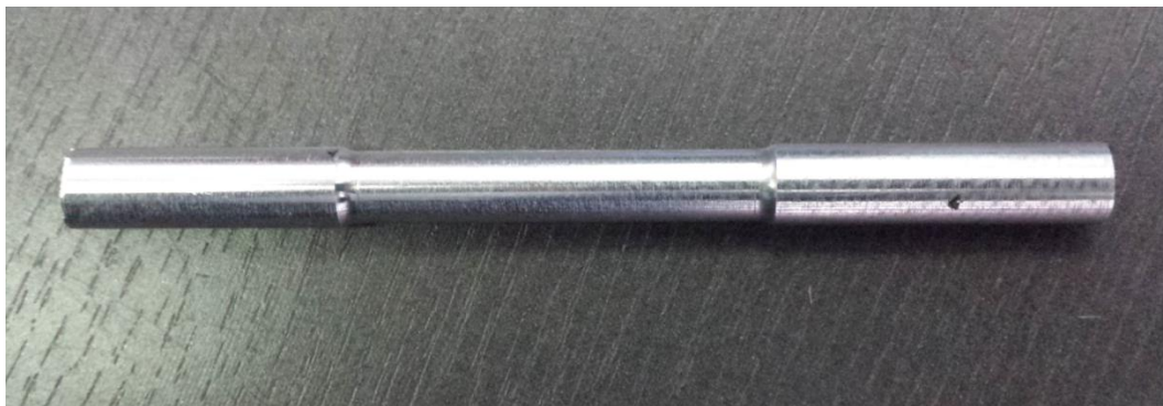
Slika 52. Epruveta za statički vlačni pokus
