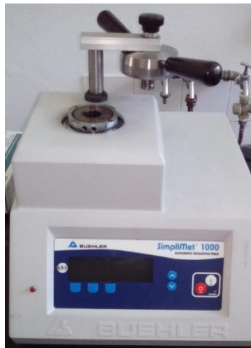
Slika 54. Uređaj tipa Buehler za zalijevanje uzoraka na toplo
