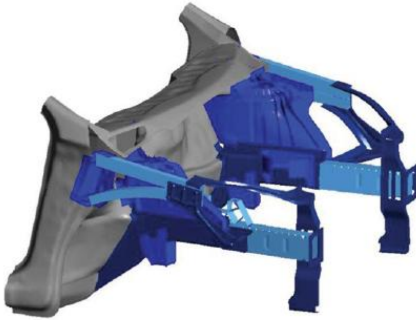
Slika 40. Prednji dio karoserije izrađen iz aluminija [25]
