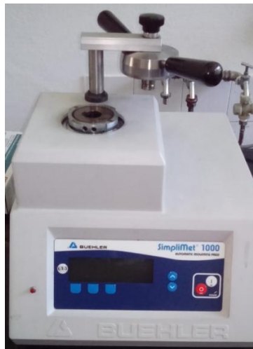
Slika 54. Uređaj tipa Buehler za zalijevanje uzoraka na toplo
