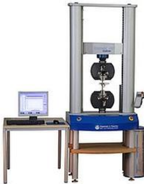
Slika 51. Kidalica tipa H&P Inspekt Table 100 [30]
