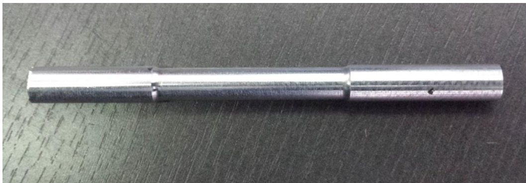
Slika 52. Epruveta za statički vlačni pokus
