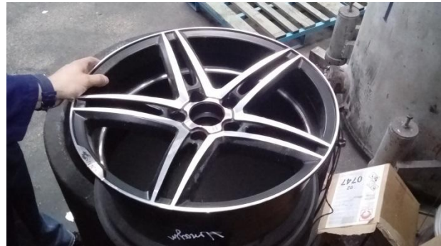
Slika 47. Lijevanje uzoraka AlSi7Mg legure
