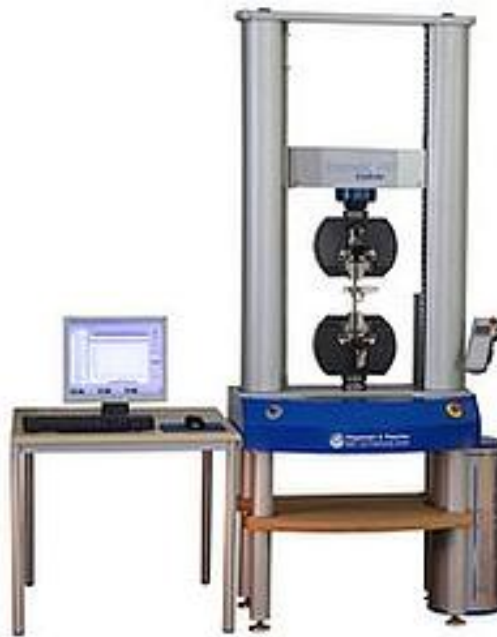
Slika 51. Kidalica tipa H&P Inspekt Table 100 [30]
