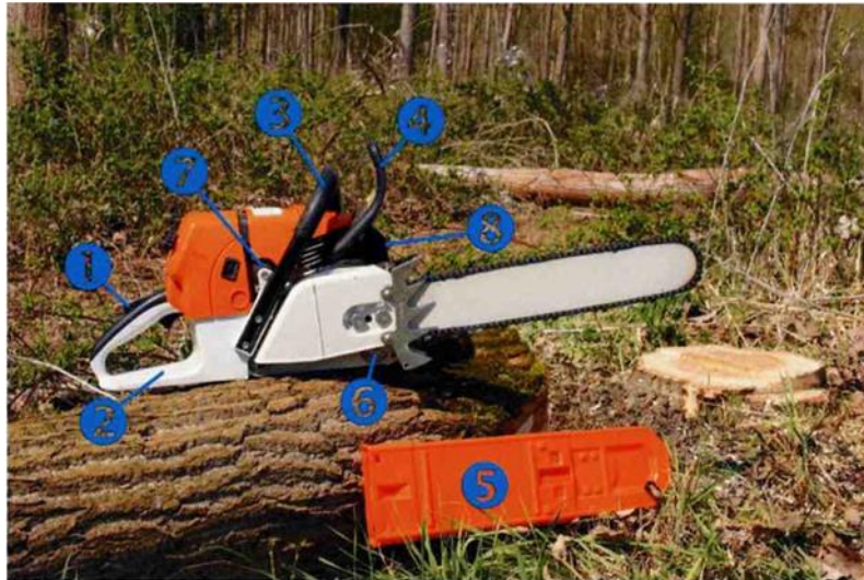
Slika 6. Zaštitne naprave na motornoj pili [6]
