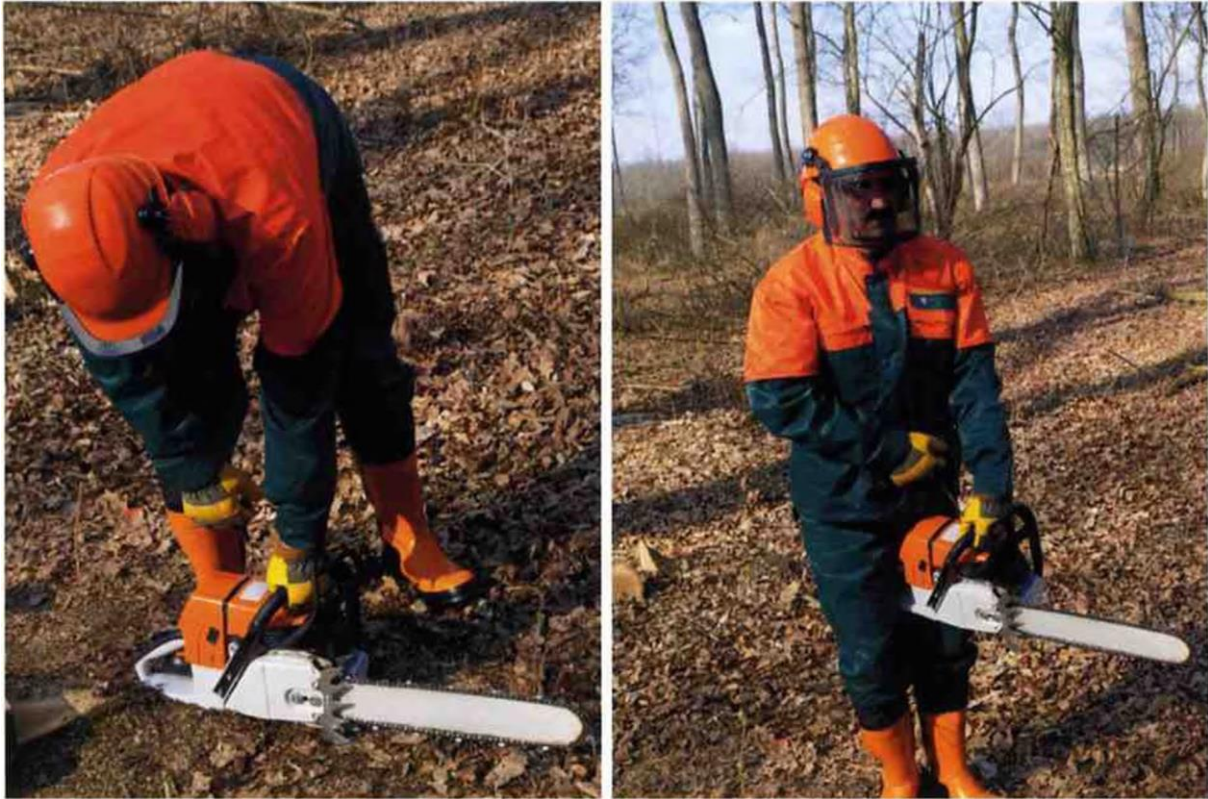
Slika 7. Stavljanje motorne pile u pogon na zemlji i u zraku [6]
