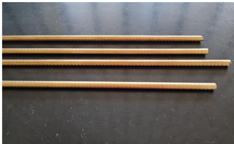
Slika 9. Fotografski snimak lijevane šipke CuAlNi legure s prisjetljivosti oblika
