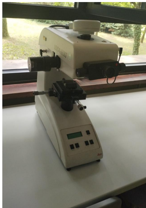
Slika 14. Tvrdomjer Leica VHMT
