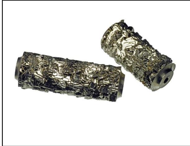
Slika 3. Titanov kristal dobiven van Arkel - de Boer postupkom [20]
