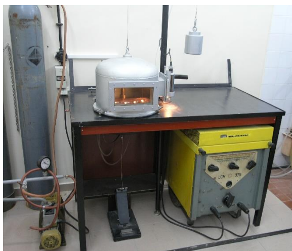
Slika 5. Laboratorijska elektrolučna peć na Metalurškom fakultetu [11]
