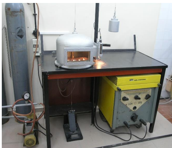
Slika 5. Laboratorijska elektrolučna peć na Metalurškom fakultetu [11]
