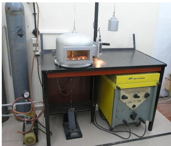
Slika 5. Laboratorijska elektrolučna peć na Metalurškom fakultetu [11]
