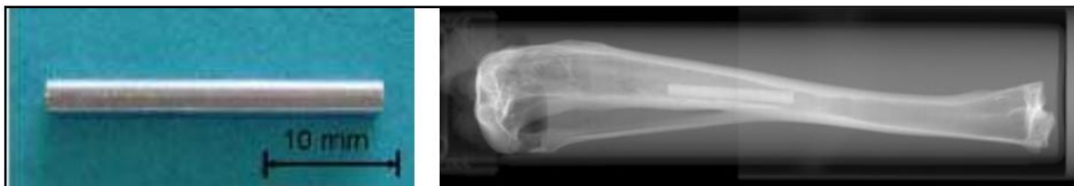
Slika 9. Ekstrudirana magnezijeva igla (a) i radiografska slika mjesta implantata u goljениčnoj kosti kunića (b) [34]
