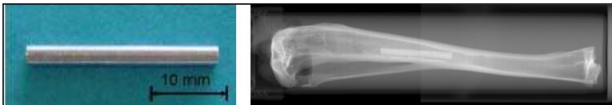
Slika 9. Ekstrudirana magnezijeva igla (a) i radiografska slika mjesta implantata u goljeničnoj kosti kunića (b) [34]
