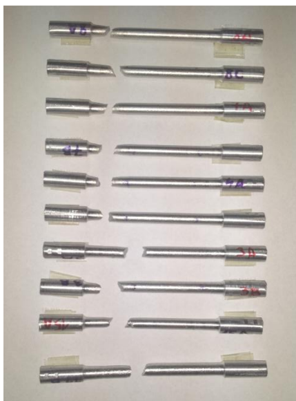
Slika 40. Epruvete nakon statičkog vlačnog ispitivanja
