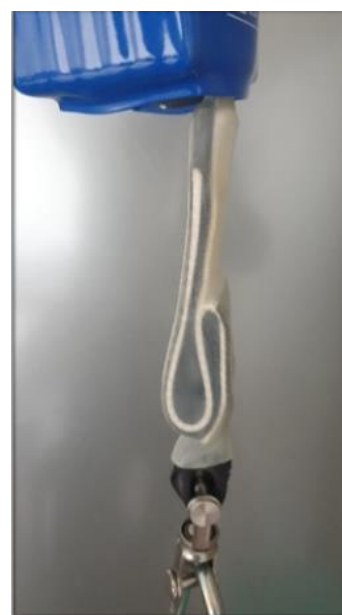
Slika 23. Dio koji označuje neupotrebljivost pojasa
