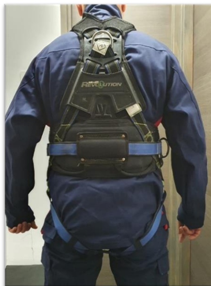
Slika 16. Kombinirani radni pojas (odostraga)
