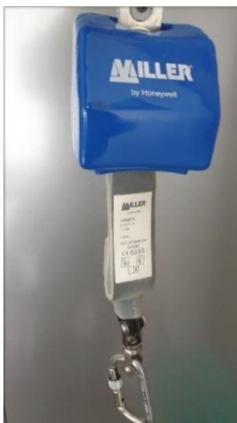
Slika 21. Naprava za zaustavljanje pada
