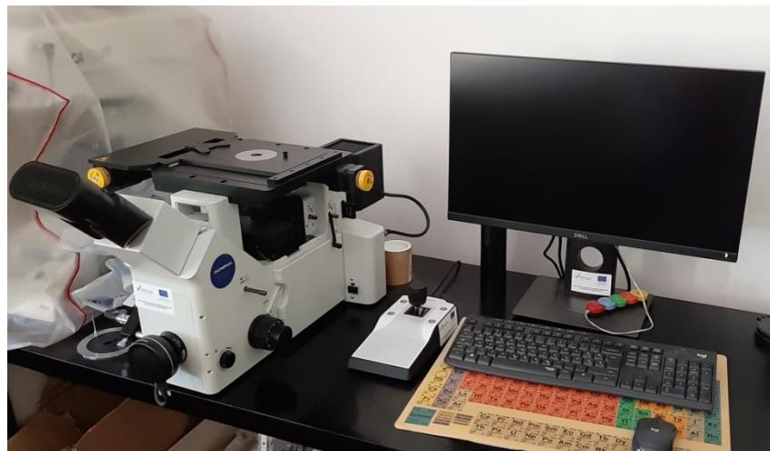
Slika 24. Invertni metalografski mikroskop Olympus GX51 s digitalnom kamerom DP70
