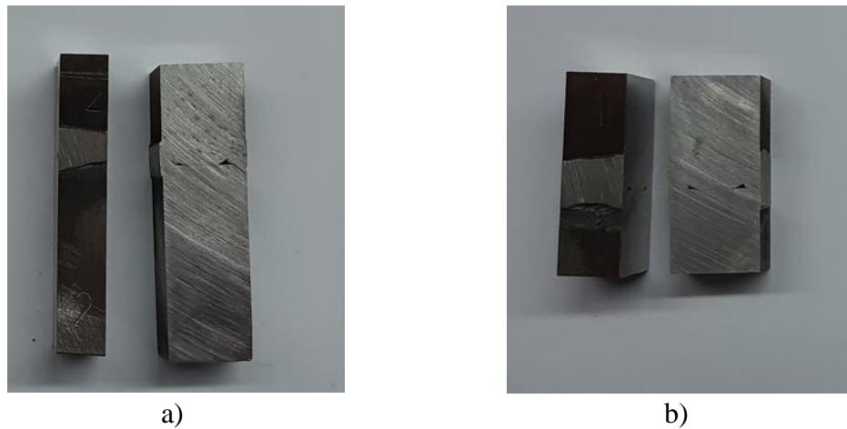
Slika 20. Izrezani uzorci: a) spoja hlađenog na zraku, b) spoja hlađenog u vodi
