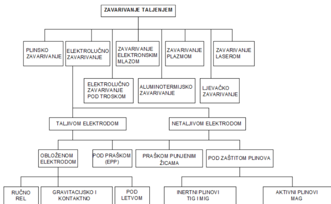
Slika 4. Podjela postupaka zavarivanja taljenjem [5]
