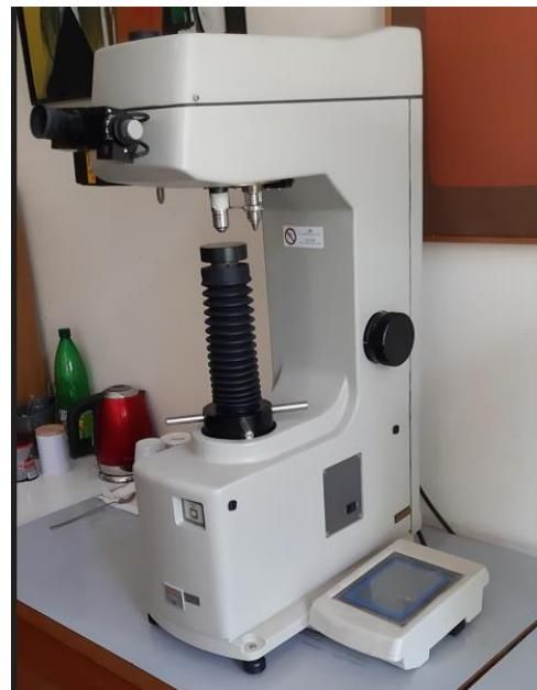
Slika 25. Uredaj Mitutoyo za mjerjenje tvrdoće metodom po Vickersu
