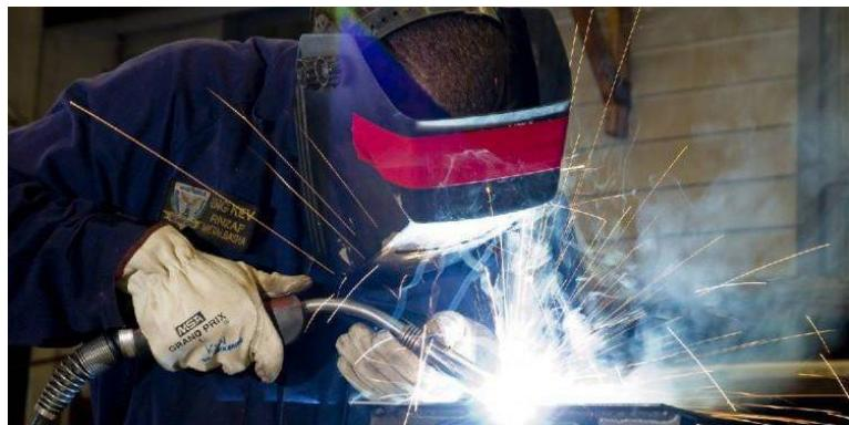
Slika 1. Primjena MIG postupka zavarivanja [3]
