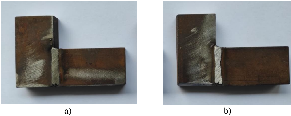
Slika 18. Uzorak: a) hlađen na zraku, b) hlađen u vodi
