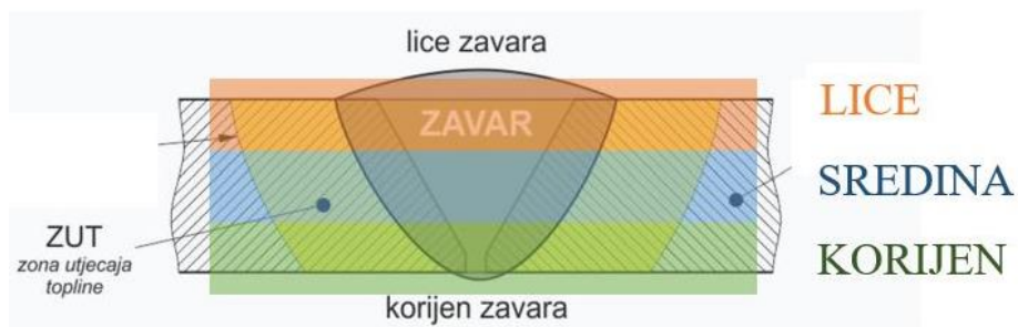
Slika 27. Područja mjerenja tvrdoće
