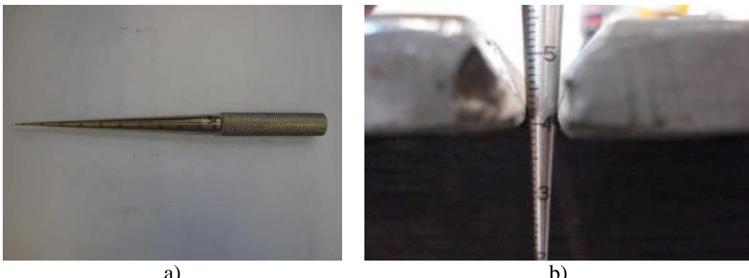
Slika 28. Mjerilo za mjerjenje razmaka [27]: a) mjerilo, b) pravilna primjena mjerila
