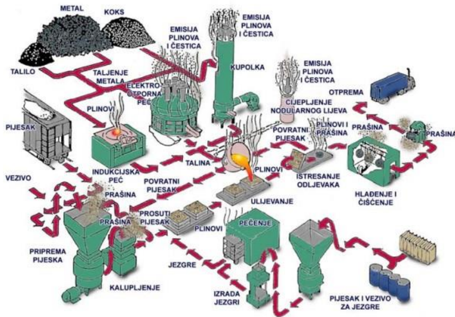
Slika 3. Shematski prikaz procesa u ljevaonicama [14]
