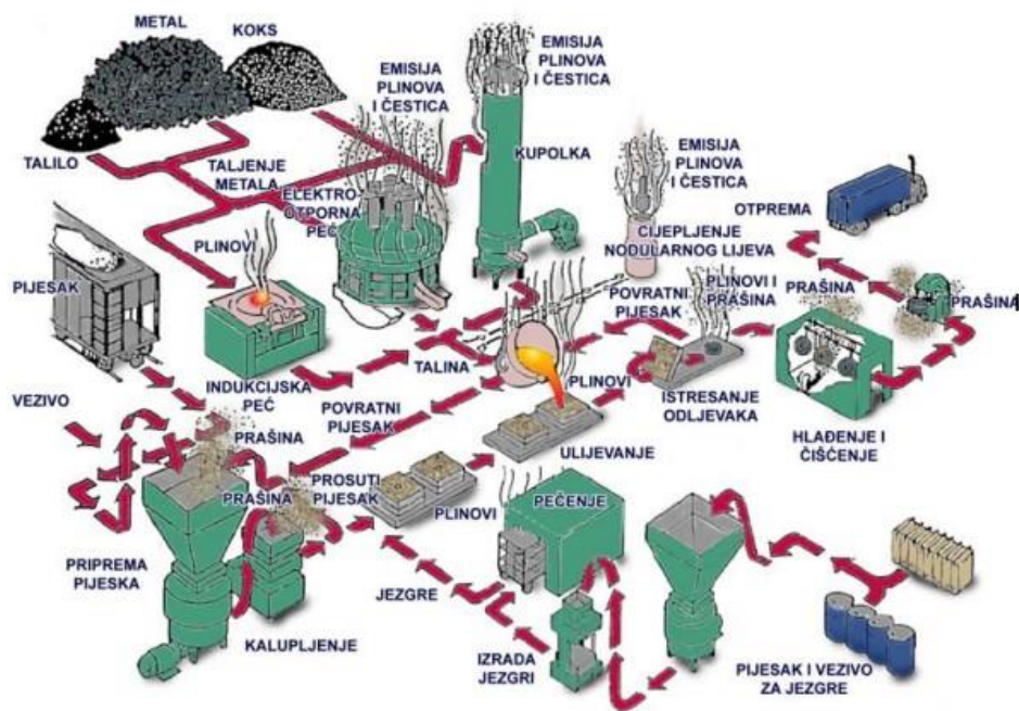
Slika 3. Shematski prikaz procesa u ljevaonicama [14]
