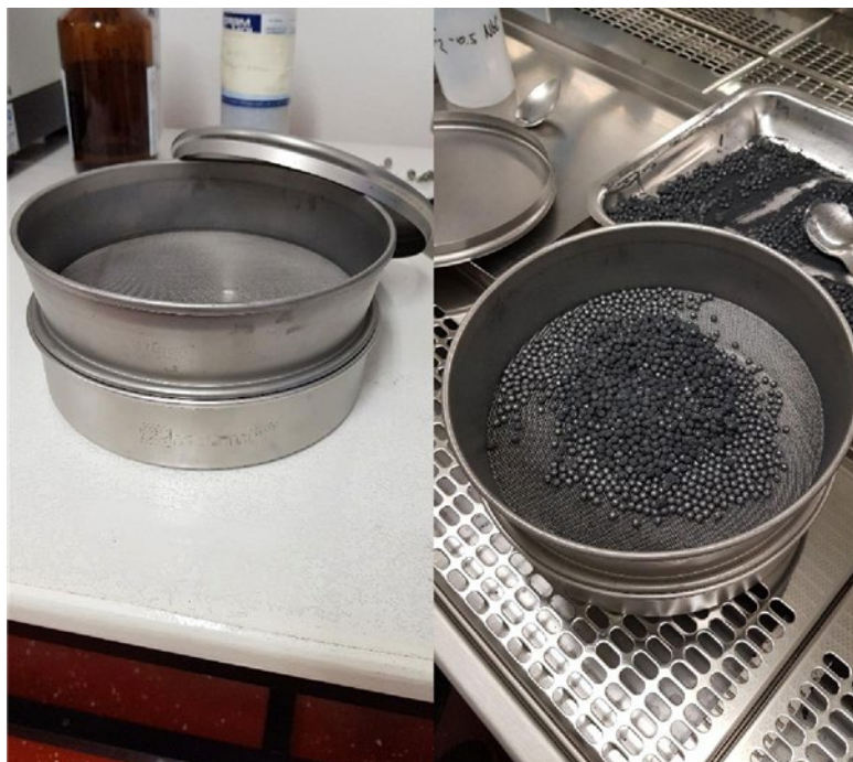
Slika 8.4. Granuliranje praškaste mješavine: a) sito, b) kuglice od tvrdog metala i praškasta mješavina
