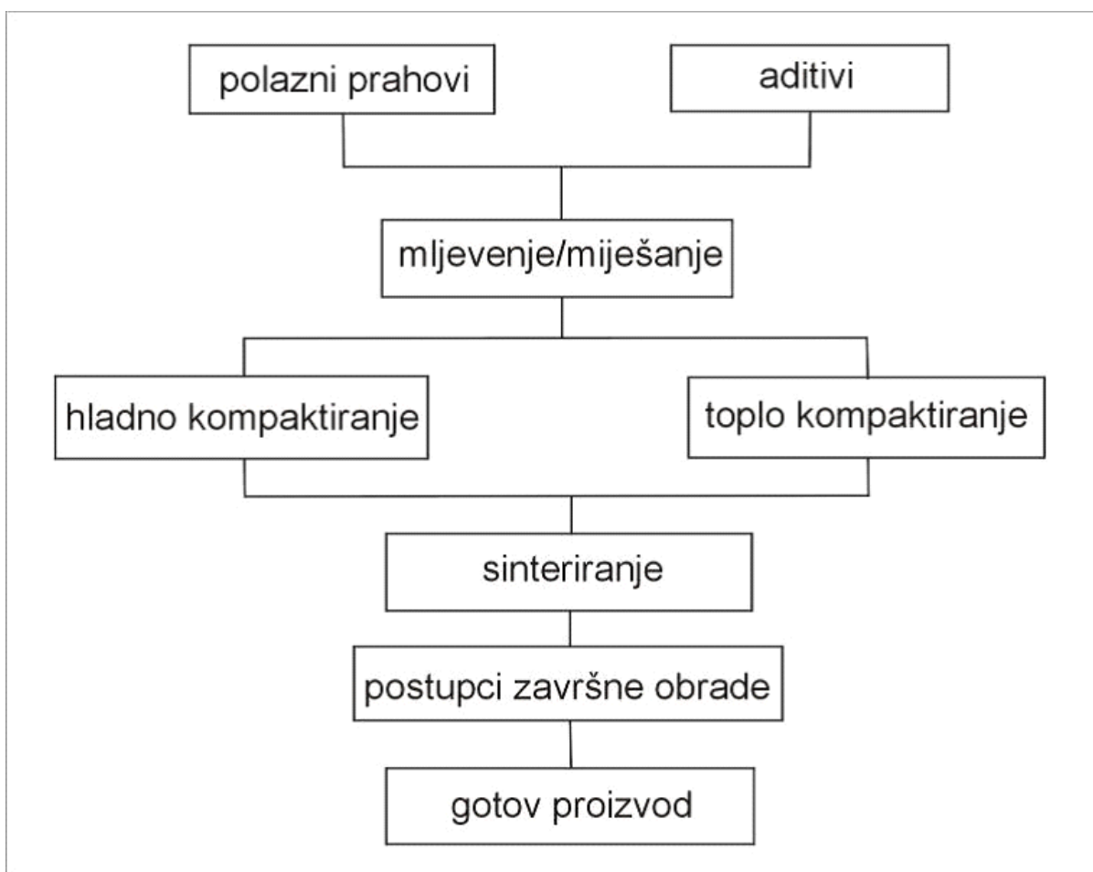
Slika 2.2. Hodogram tehnoloških operacija konvencionalnih postupaka metalurgije praha [4]
