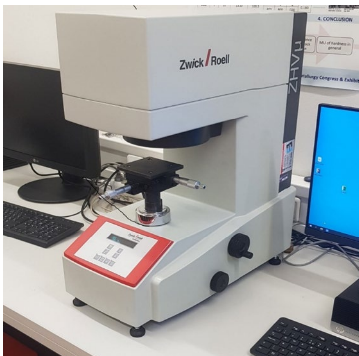
Slika 8.6. Optički mjerni sustav tvrdomjera Zwick/Roell
