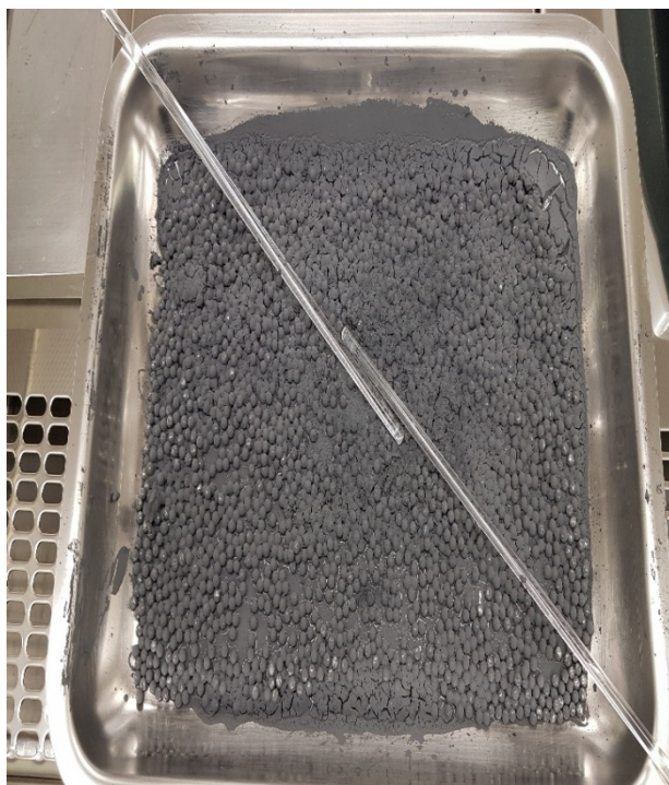
Slika 9.1. Mješavina prahova nakon sušenja
