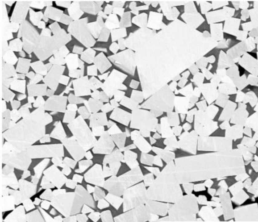
Slika 7.1. - Mikrostruktura WC/Co tvrdog metala [23]
