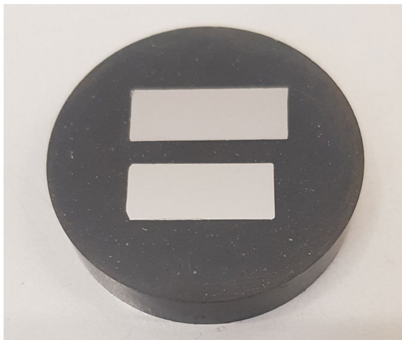
Slika 9.3. Istraživani uzorak nanostrukturiranog tvrdog metala WC-FeNi
