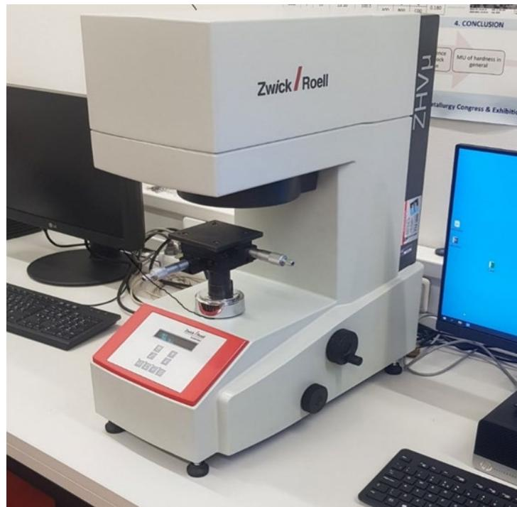
Slika 8.6. Optički mjerni sustav tvrdomjera Zwick/Roell
