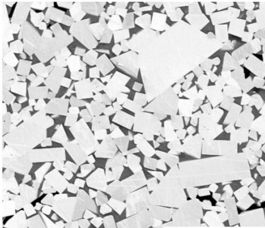
Slika 7.1. - Mikrostruktura WC/Co tvrdog metala [23]
