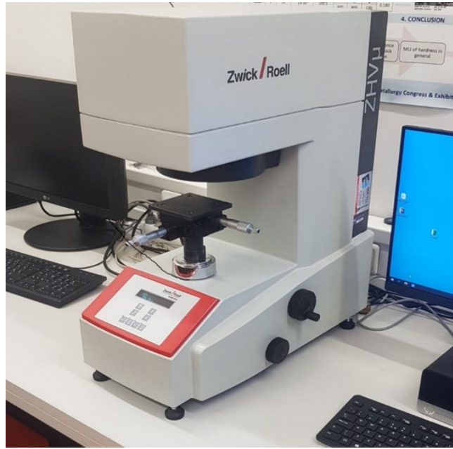
Slika 8.10. Uređaj za ispitivanje tvrdoće metodom po Vickersu, Zwick/Roell
