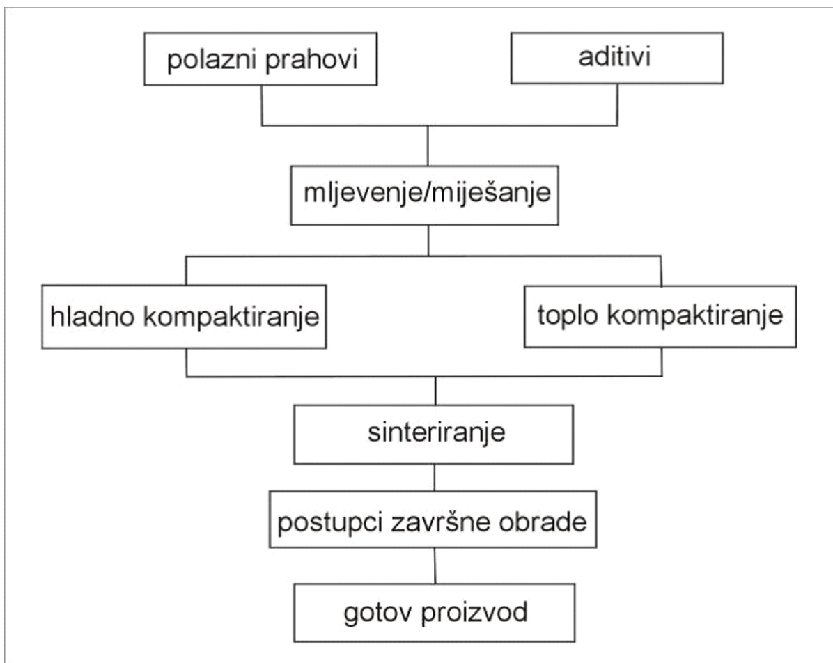
Slika 2.2. Hodogram tehnoloških operacija konvencionalnih postupaka metalurgije praha [4]
