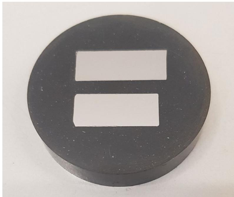
Slika 9.3. Istraživani uzorak nanostrukturiranog tvrdog metala WC-FeNi
