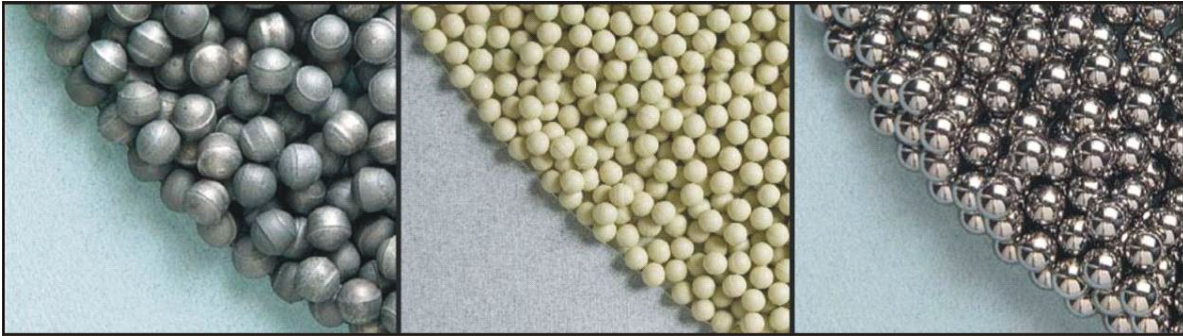
Slika 3.3. Kuglice za mljevenje izrađene od različitih materijala [5]
