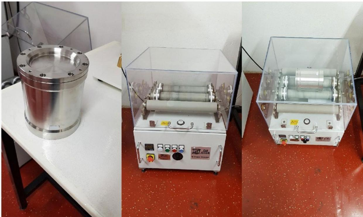
Slika 8.2. Horizontalni kuglični mlin
