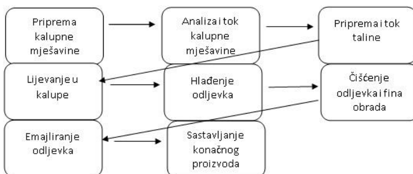
Slika 12. Tijek proizvodnje odljevka u Plemenu d.o.o.
