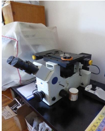
Slika 36. Invertni metalografski mikroskop Olympus GX 71s digitalnom kamerom DP7
