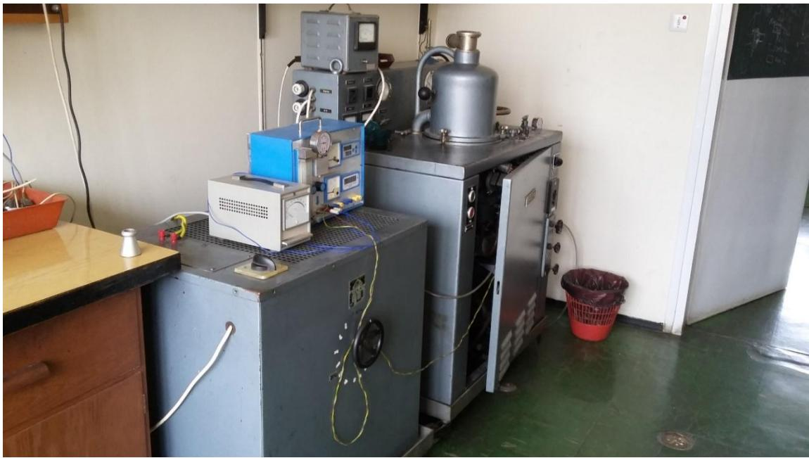
Slika 5.6. Protočna peć za sinteriranje
