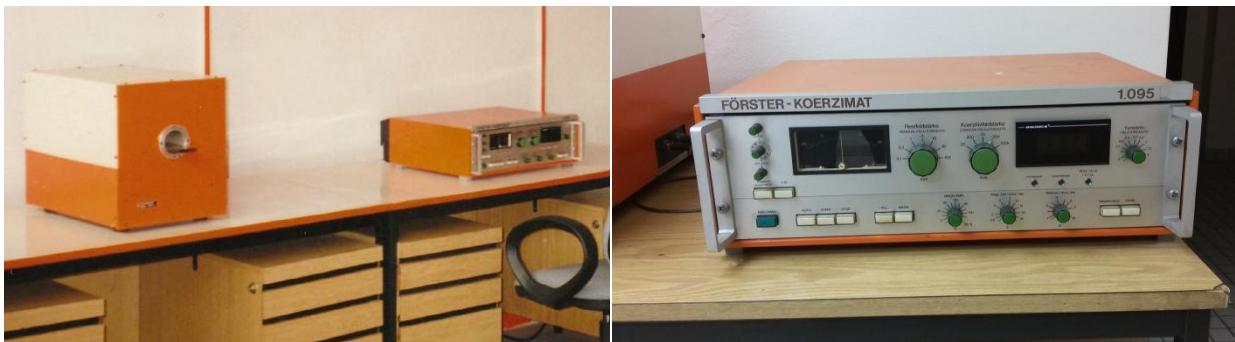
Slika 5.11. Uređaj za mjerjenje koercitivne sile
