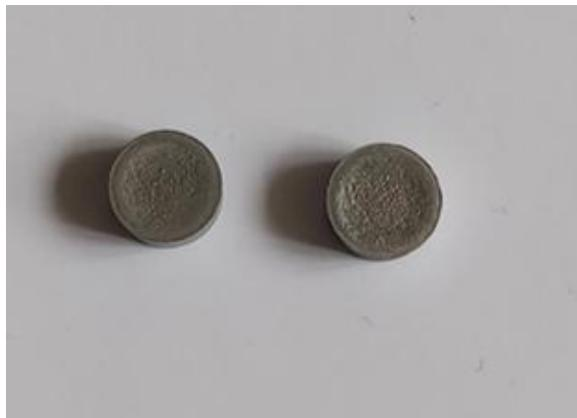
Slika 6.1. Uzorci 1 i 2 nakon kompaktiranja
