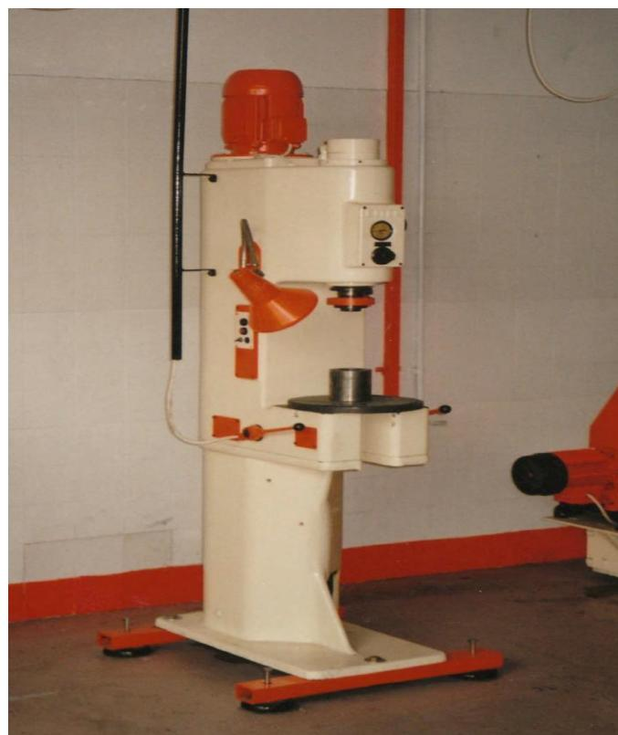
Slika 5.5. Hidraulička preša Eitel
