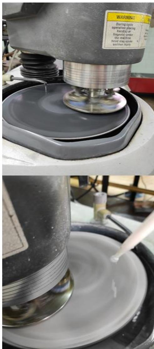
Slika 5.12. Brušenje i poliranje uzorka
