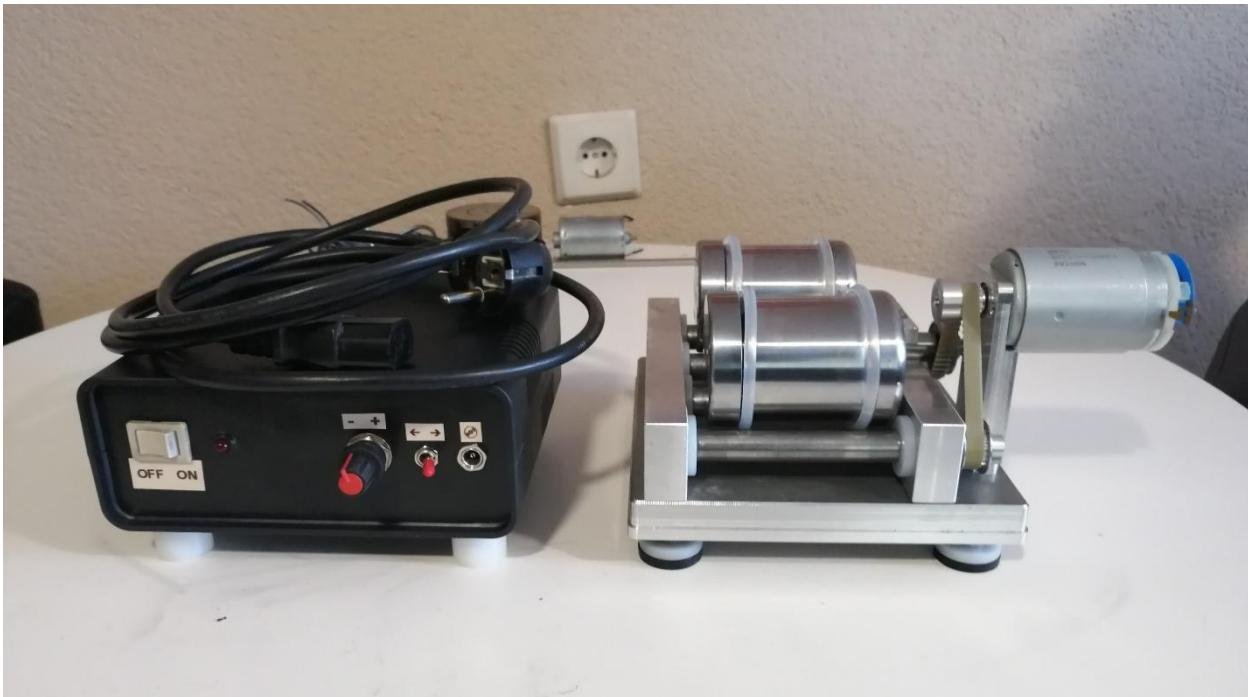
Slika 5.3. Horizontalni kuglični mlin
