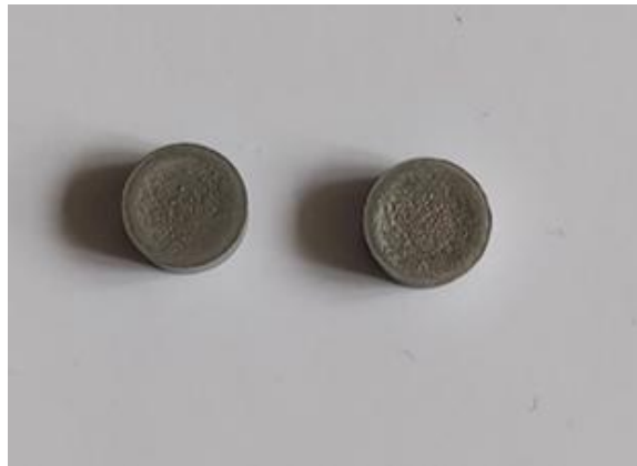
Slika 6.1. Uzorci 1 i 2 nakon kompaktiranja
