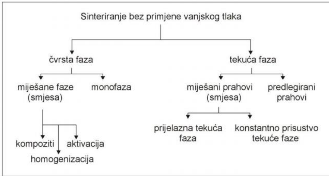
Slika 4.5. Shematski prikaz podjele sinteriranja bez utjecaja vanjskog tlaka [6]
