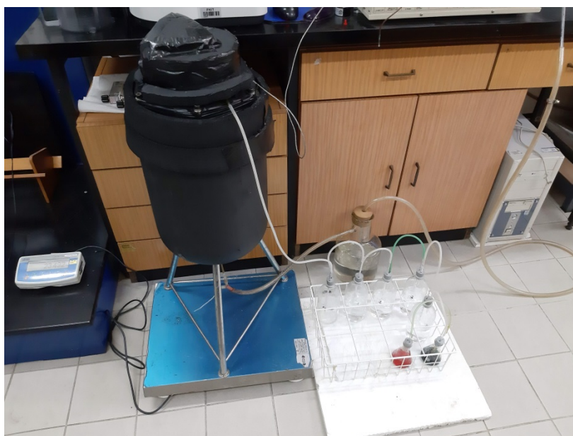
Slika 21. Fotografiska snimka reaktora za kompostiranje (FKIT)
