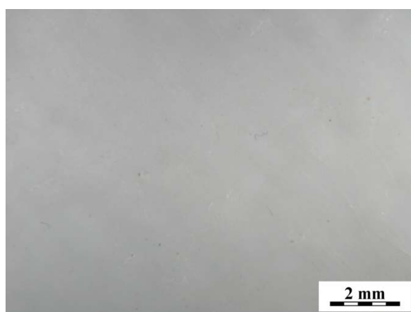
Slika 31. Mikrostruktura čistog TPS-a prije kompostiranja
