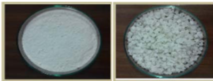
Slika 15. Fotografija prirodnog pšeničnog škroba (lijevo) i granule pripremljenog termoplastičnog pšeničnog škroba (desno)
