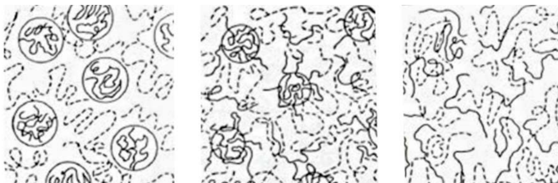
Slika 10. Polimerne mješavine polimera A označenog punom linijom i polimera B označenog isprekidanom linijom, sa lijeva na desno: nemješljiva, djelomično mješljiva i mješljiva mješavina polimera [24]
