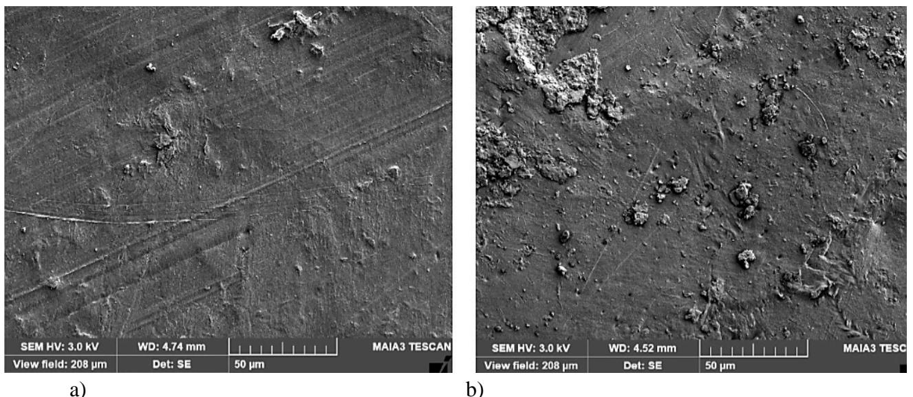
**Slika 40.** SEM mikrofotografije polimerne PE-LD/10 TPS mješavine;
