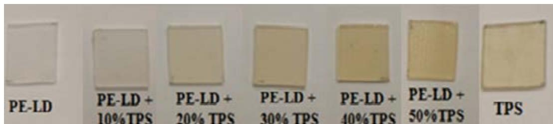
**Slika 18.** Dobiveni uzorci polimernih PE-LD/TPS mješavina
