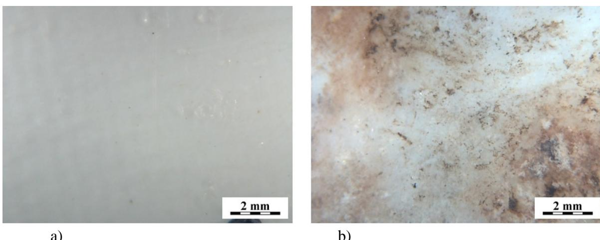
**Slika 35.** Mikrostruktura polimerne PE-LD/30TPS mješavine
