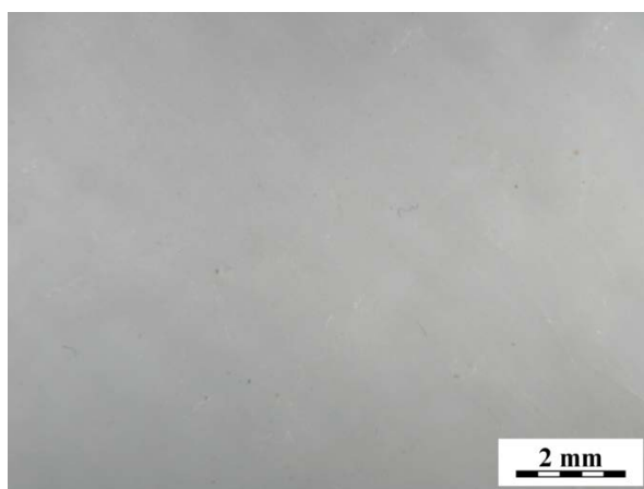
Slika 31. Mikrostruktura čistog TPS-a prije kompostiranja
