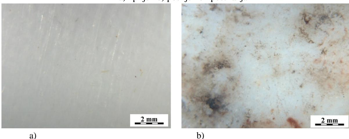
**Slika 34.** Mikrostruktura polimerne PE-LD/20TPS mješavine
