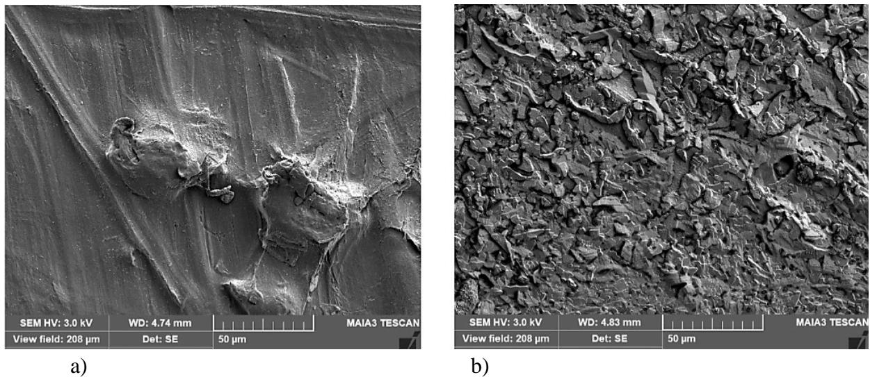
**Slika 43.** SEM mikrofotografije polimerne PE-LD/40 TPS mješavine;
