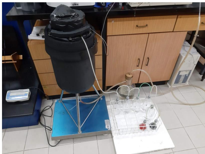
**Slika 21.** Fotografska snimka reaktora za kompostiranje (FKIT)
