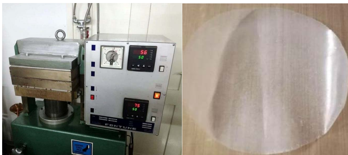
Slika 17. a) Hidraulička preša Fortuna , b) uzorak nakon prešanja
