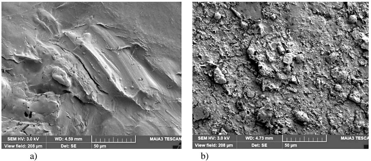
**Slika 44.** SEM mikrofotografije polimerne PE-LD/50 TPS mješavine;
