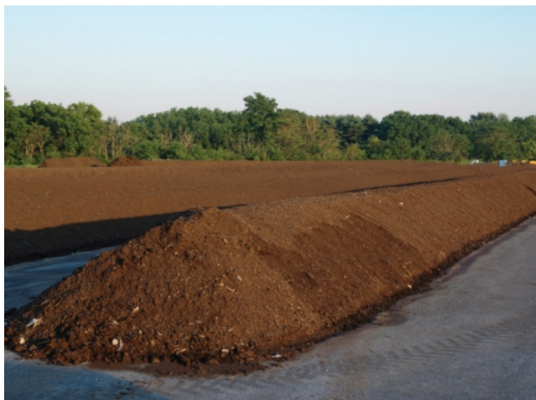
Slika 12. Primjer otvorenog sustava kompostiranja [33]
