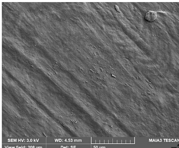
**Slika 38.** SEM mikrofotografija čistog TPS-a prije kompostiranja
