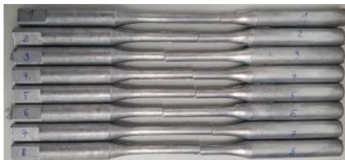
Slika 32. Epruvete nakon ispitivanja vlačne čvrstoće
