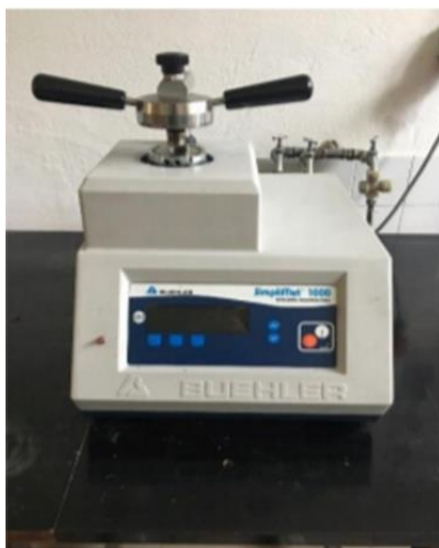
Slika 34. Uređaj za ulaganje u masu SimpliMet 1000
