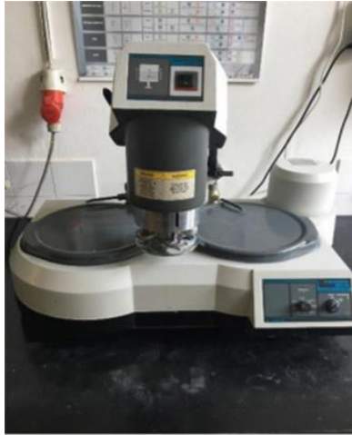
Slika 35. Uređaj za brušenje i poliranje uzoraka PHOENIX BETA GRINDING/POLISHER s glavom Vector LC
