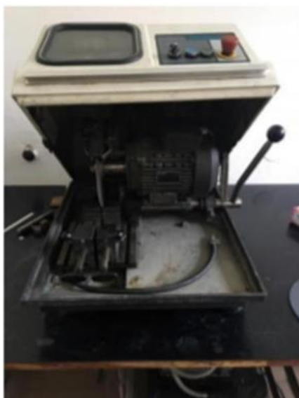
Slika 33. Uređaj za rezanje uzoraka Buehler ABRASIMET 2
