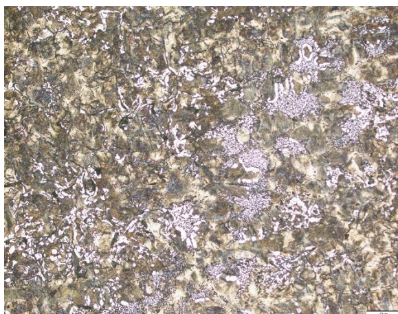
Slika 25. Snimljena mikrostruktura sivog lijeva EN-GJL-250 pri povećanju 100X u nagriženom stanju
