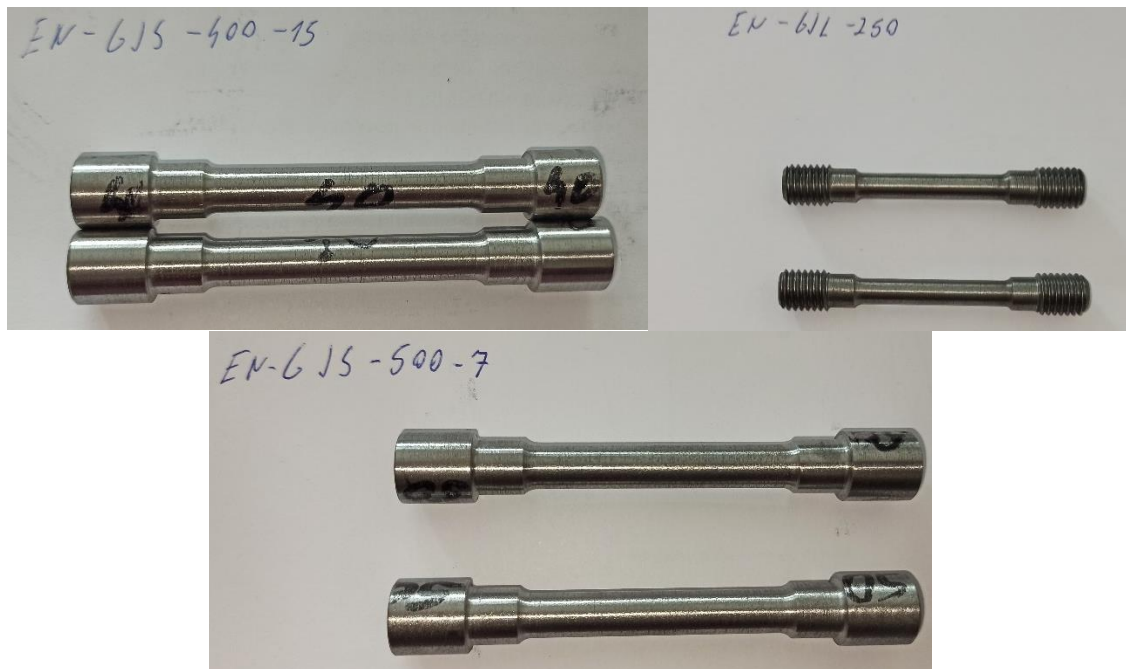
Slika 14. Uzorci za statički vlačni pokus prije ispitivanja
