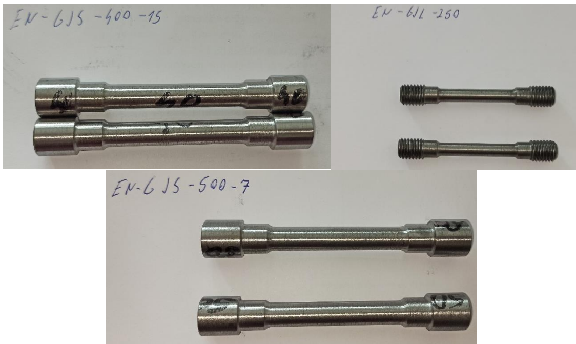
Slika 14. Uzorci za statički vlačni pokus prije ispitivanja
