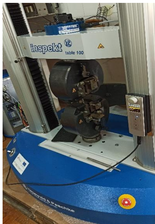
Slika 15. Uređaj za ispitivanje vlačnih svojstava Inspekt table Hegewald Peschke 100kN
