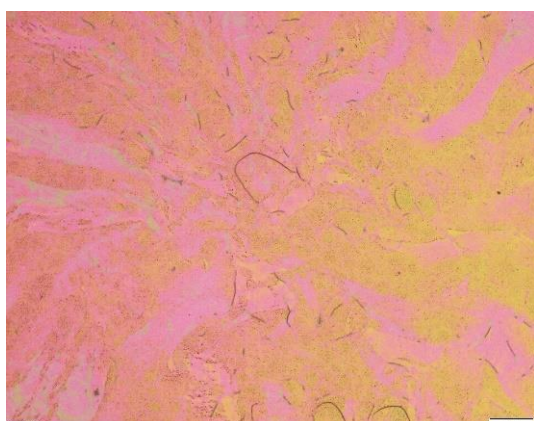
Slika 51. Mikrostruktura bakrene žice nakon redukcije 67,5% u središtu
