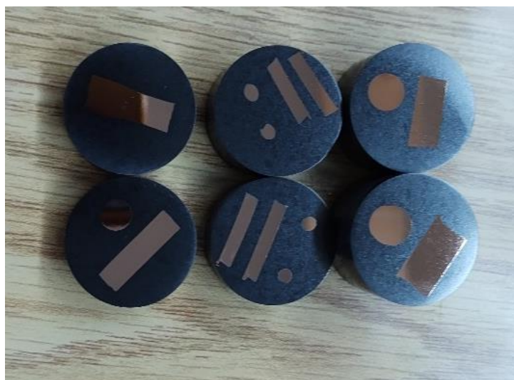
Slika 31. Izgled uzoraka nakon brušenja i poliranja
