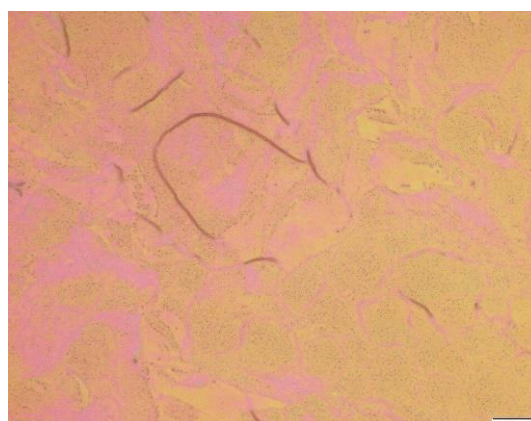
Slika 51. Mikrostruktura bakrene žice nakon redukcije 67,5% u središtu
