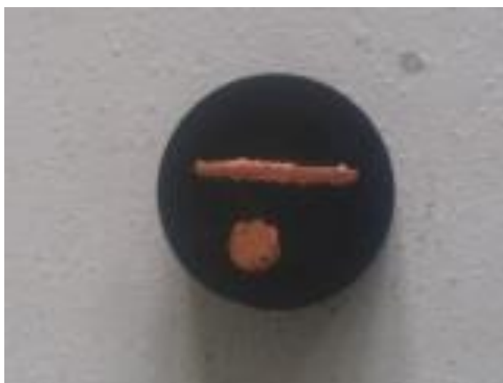
Slika 29. Uzorak bakrene žice uložen u vodljivu masu
