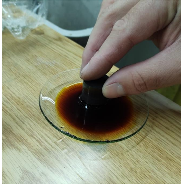
Slika 32. Nagrizanje uzorka bakrene žice
