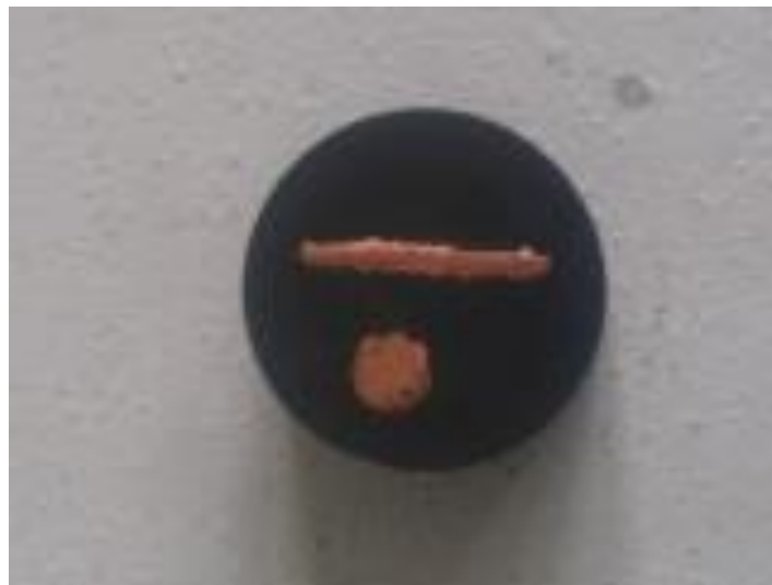
Slika 29. Uzorak bakrene žice uložen u vodljivu masu
