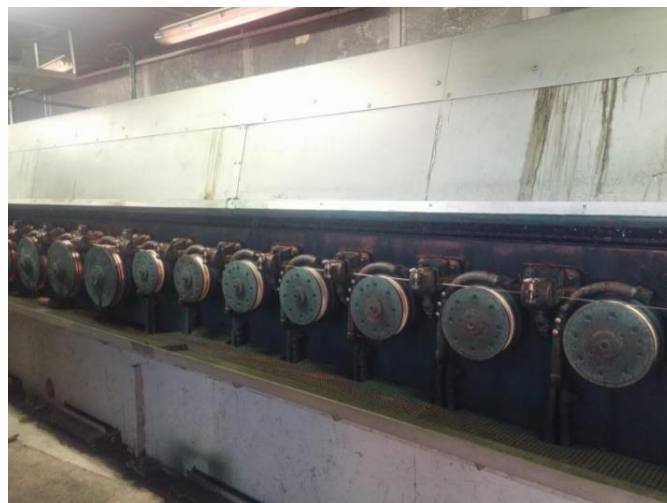
Slika 27. Strojevi za kontinuirano izvlačenje žice
