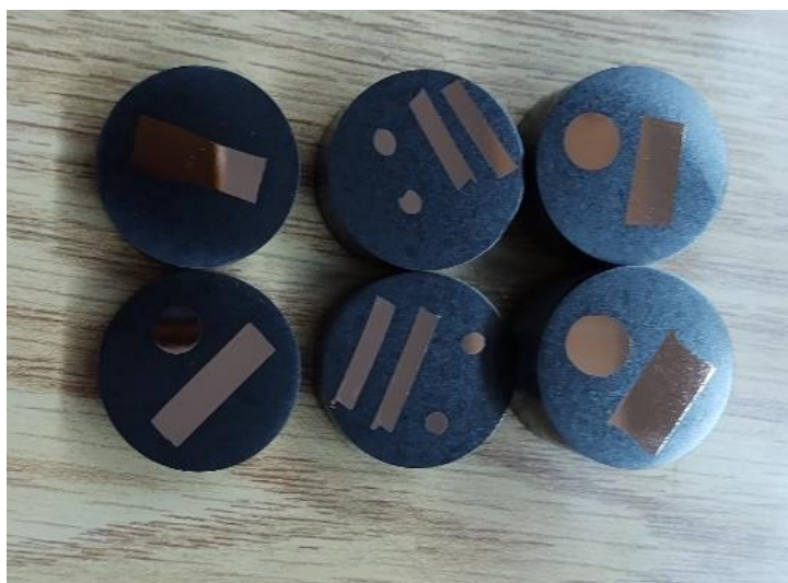
Slika 31. Izgled uzoraka nakon brušenja i poliranja
