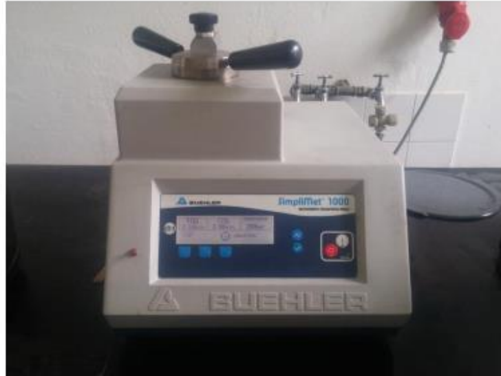
Slika 28. Buehler Simplimet1000 uređaj za pripremu uzorka za metalografsku analizu
