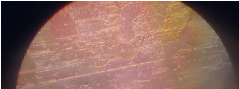
Slika 33. Uzorak prije nagrizanja.
