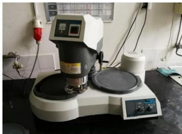
Slika 35. Uređaj Buehler za brušenje i poliranje uzoraka
