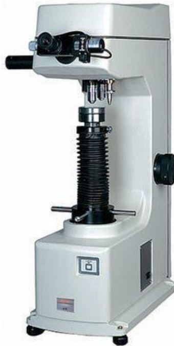
Slika 40. Tvrdomjer Mitutoyo Hardness Testing Machine HV
