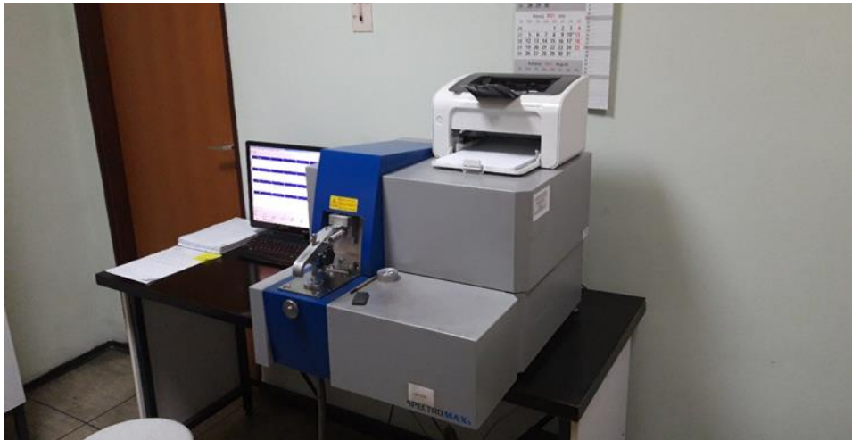
Slika 32. Uređaj Spectromaxx za određivanje kemijskog sastava taline
