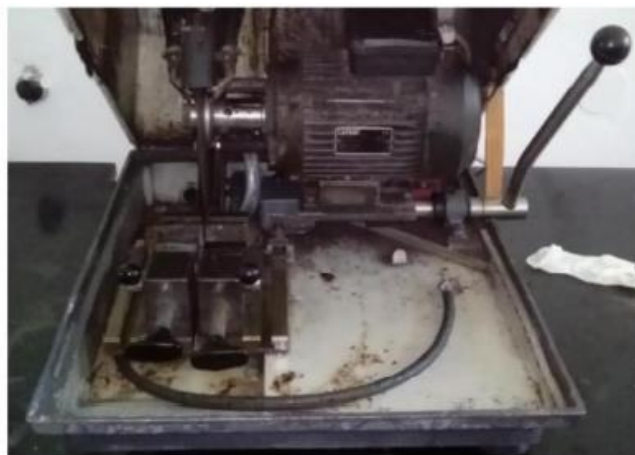
Slika 33. Rezalica Buehler za rezanje uzoraka
