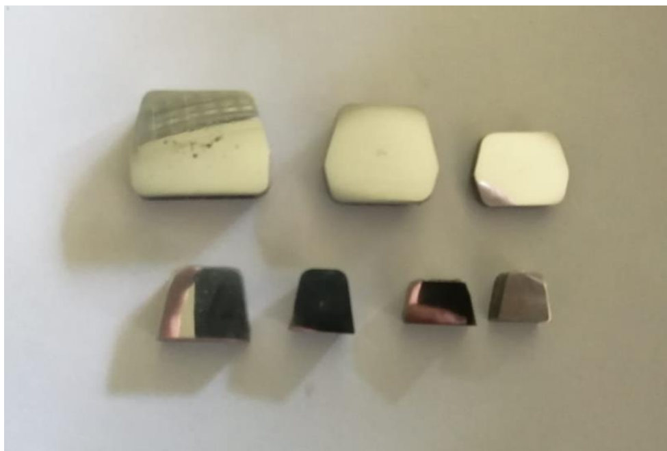
Slika 36. AISi12 uzorci za metalografska ispitivanja
