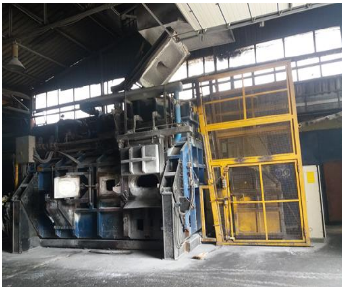
Slika 24. Peć za taljenje aluminija: a) Plinska peć Botta, b) plinski plamenik unutar peći
