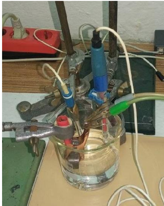
Slika 27. Staklena troelektrodna elija
