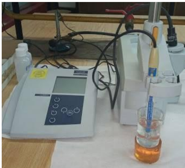
Slika 26. pH-metar, inoLab LeV1
