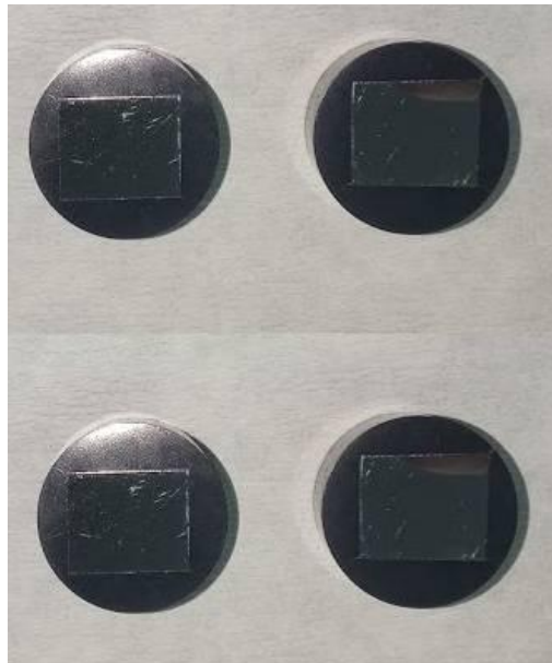
Slika 24. Uzorci alatnog elika X19NiCrMo4 prije ispitivanja
