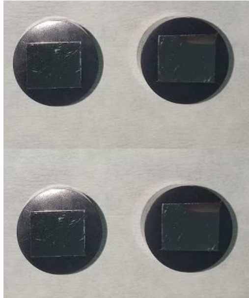
Slika 24. Uzorci alatnog elika X19NiCrMo4 prije ispitivanja
