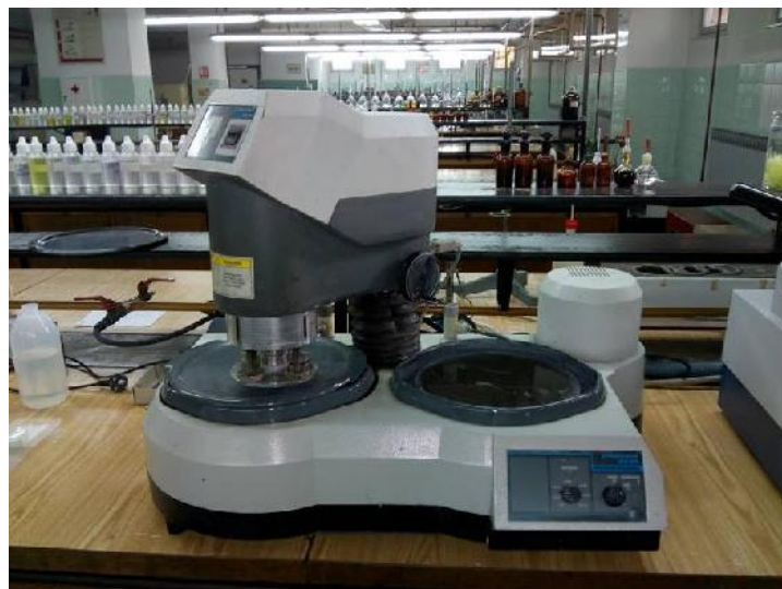
Slika 31. Automatski ure aj za brušenje i poliranje, Büehler
