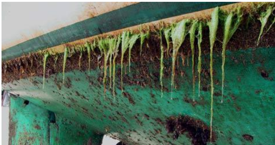
Slika 15. Primjer biokorozije na brodu i obraštaj organizmima [20]
