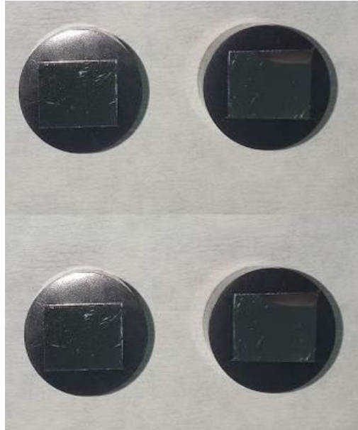
Slika 24. Uzorci alatnog elika X19NiCrMo4 prije ispitivanja
