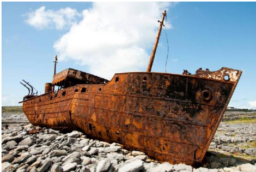
Slika 5. Primjer op e korozije, površina broda [15]
