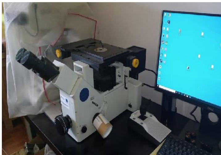
Slika 32. Svjetlosni mikroskop s digitalnom kamerom, Olympus DP27
