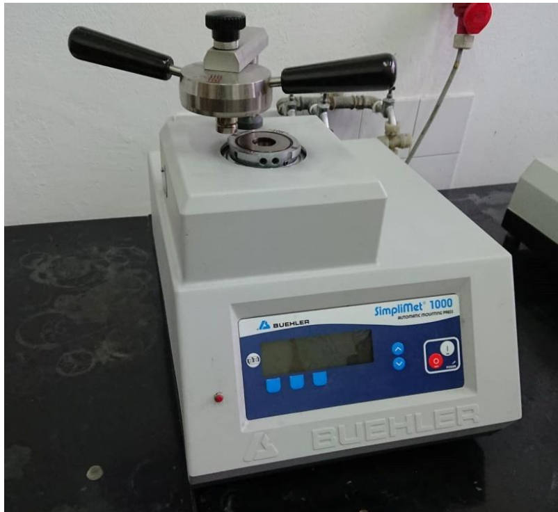
Slika 18. Uređaj za ulaganje uzoraka u ugljičnu masu postupkom vrućeg prešanja
