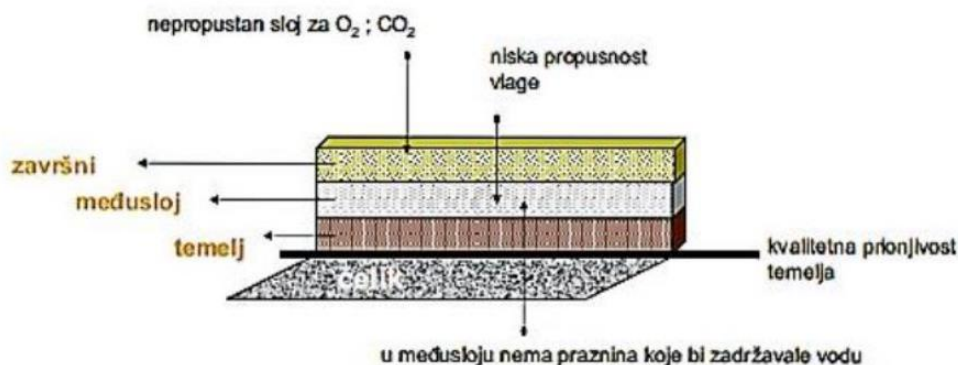
Slika 12. Slojevi organske prevlake [16]
