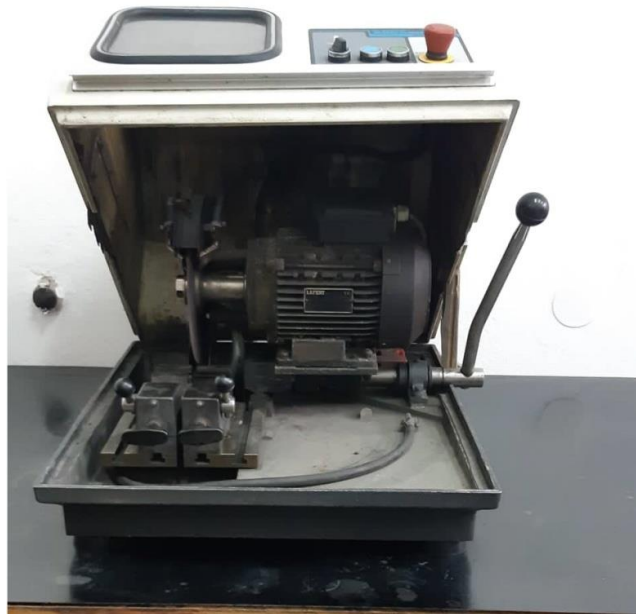
Slika 16. Uređaj za rezanje uzoraka
