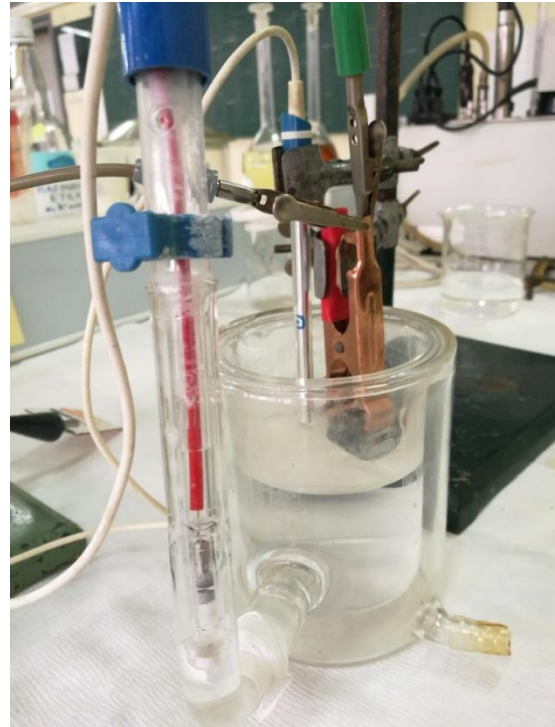
Slika 23. Troelektrodna staklena ćelija za elektrokemijska mjerenja
