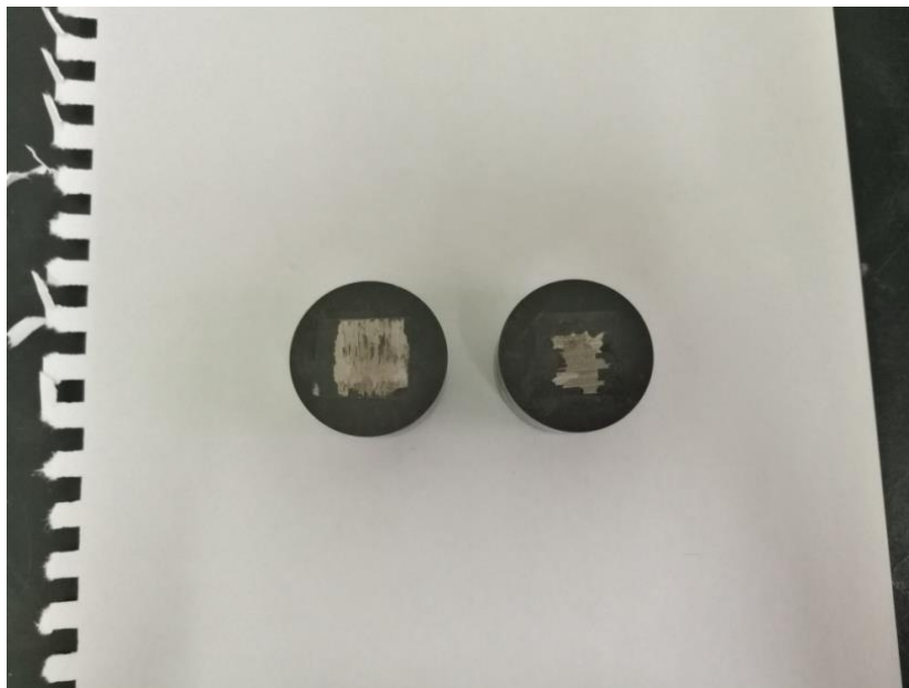
Slika 19. Uzorak nakon kalupljenja
