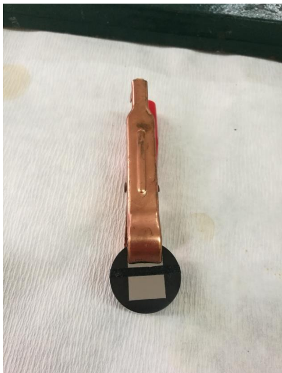
Slika 22. Uzorak pripremljen za elektrokemijska mjerenja
