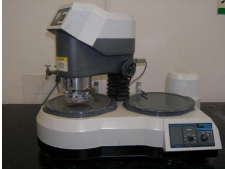
Slika 20. Uređaj za brušenje i poliranje uzoraka
