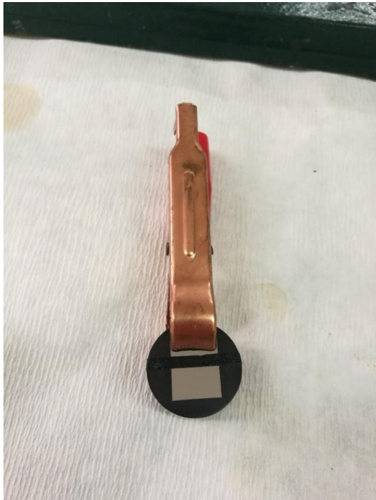
Slika 22. Uzorak pripremljen za elektrokemijska mjerenja
