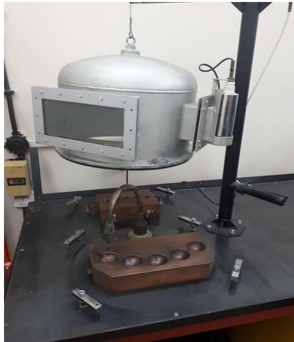
Slika 30. Laboratorijska elektrolyčna peć za taljenje i lijevanje
