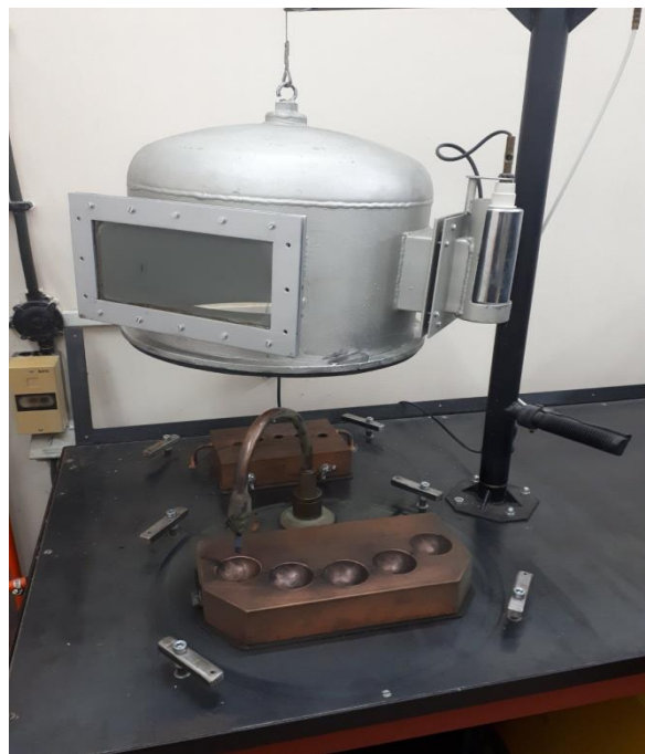
Slika 30. Laboratorijska elektrolučna peć za taljenje i lijevanje
