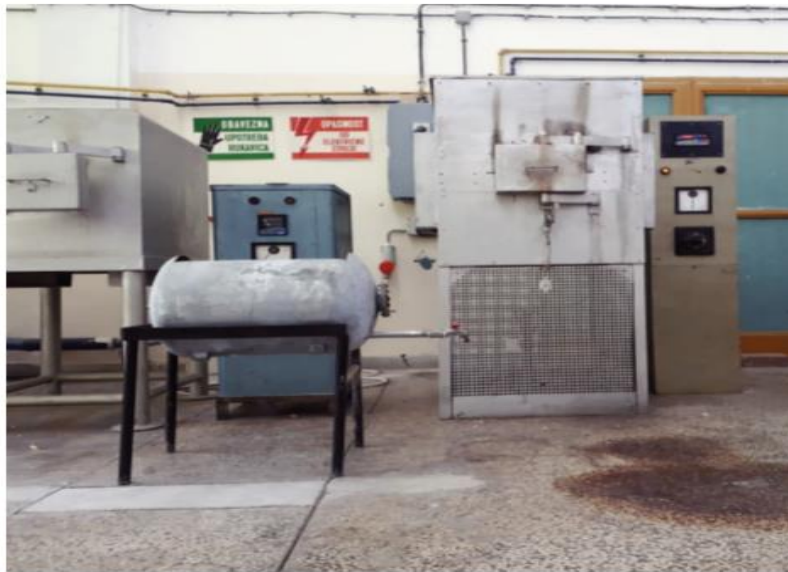
Slika 33. Elektrootporna komorna peć za žarenje
