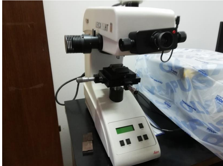
Slika 40. Mikrotvrdomjer Leica VMHT
