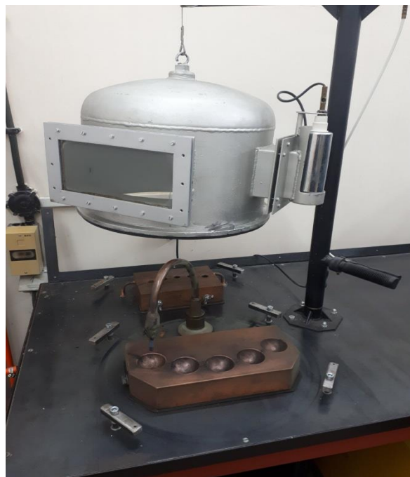
Slika 30. Laboratorijska elektrolučna peć za taljenje i lijevanje
