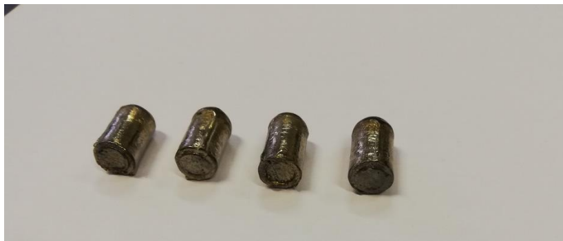
Slika 32. Uzorci Cu-Al-Mn-Zr legure proizvedeni lijevanjem u bakreni kalup
