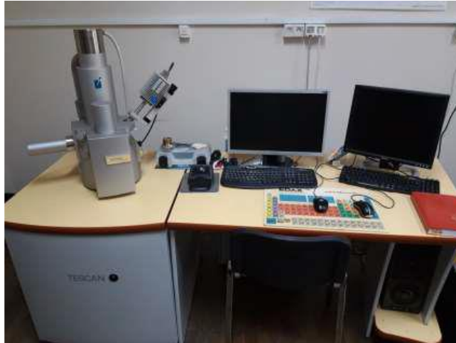
Slika 19. Scanning elektronski mikroskop Tescan Vega TS 5136 MM s EDS detektorom Bruker
