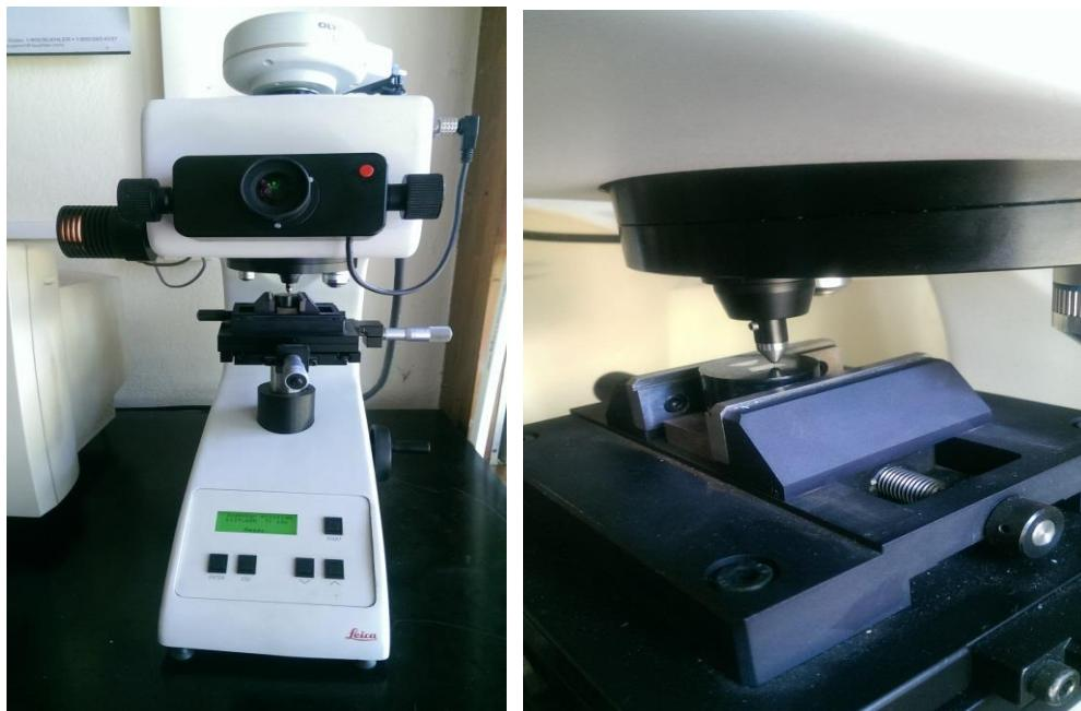
Slika 21. Tvrdomjer Leica VHMT
