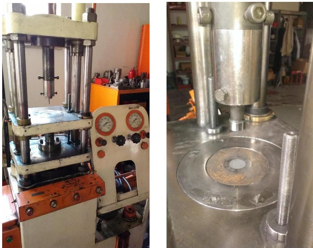
Slika 12. Hidraulična preša (lijevo) i kalup napunjen prahom (desno)
