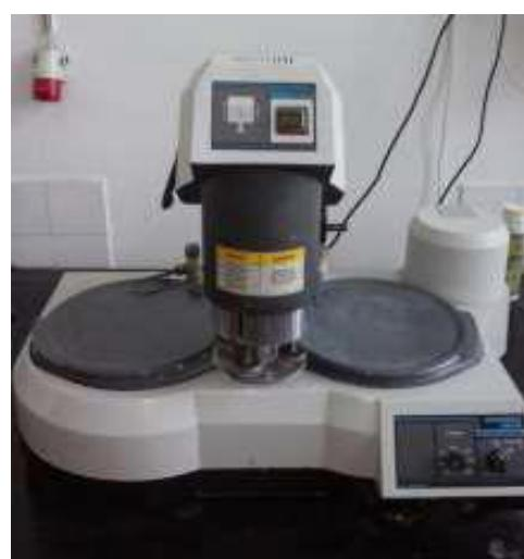
Slika 16. Uređaj za brušenje i poliranje
