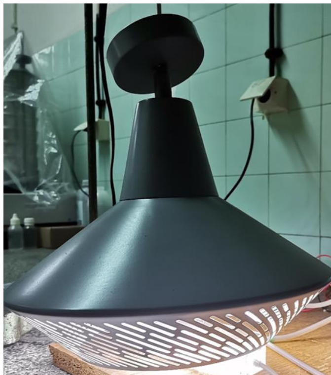
Slika 14. Prikaz glavnog dijela fotoreaktora, UV lampa
