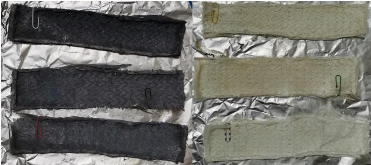
Slika 18. Simulacija starenja fotokatalizatora na zraku
