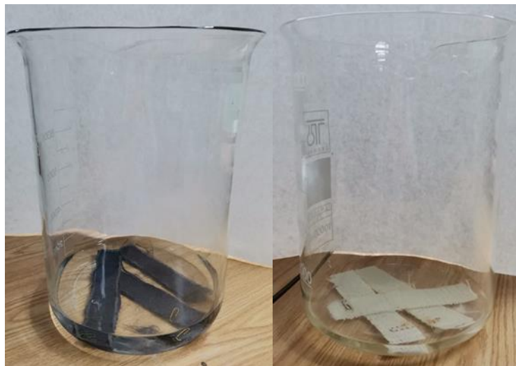
Slika 17. Simulacija starenja fotokatalizatora u vodi
