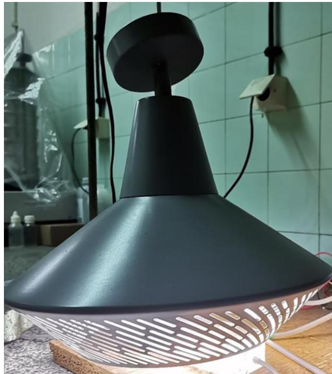
Slika 14. Prikaz glavnog dijela fotoreaktora, UV lampa
