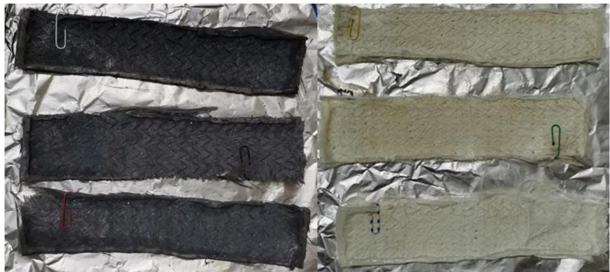
Slika 18. Simulacija starenja fotokatalizatora na zraku
