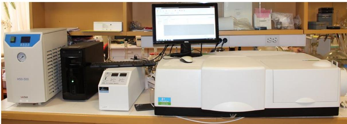
Slika 16. UV/VIS spektrofotometar [34]
