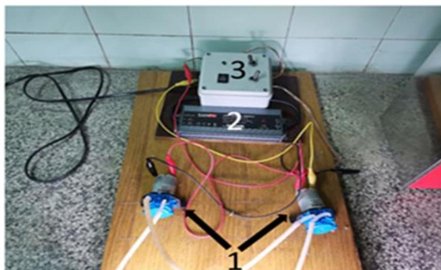
Slika 13. Prikaz dijelova fotoreaktora, 1. Peristaltičke pumpe, 2. Transformator, 3.Sklopka
