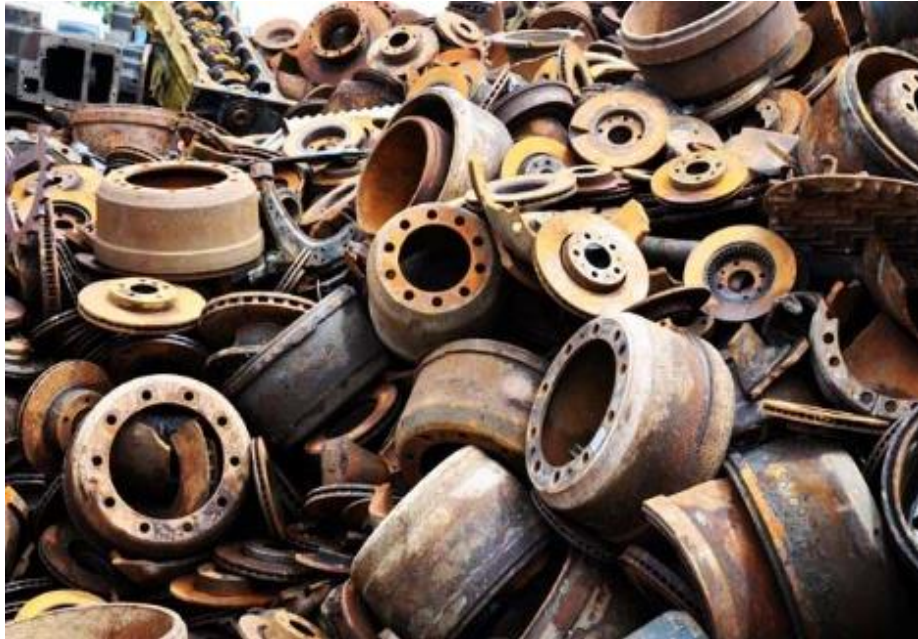
Slika 14. Čelični otpad koji se ulaže u kupolnu peć [18]
