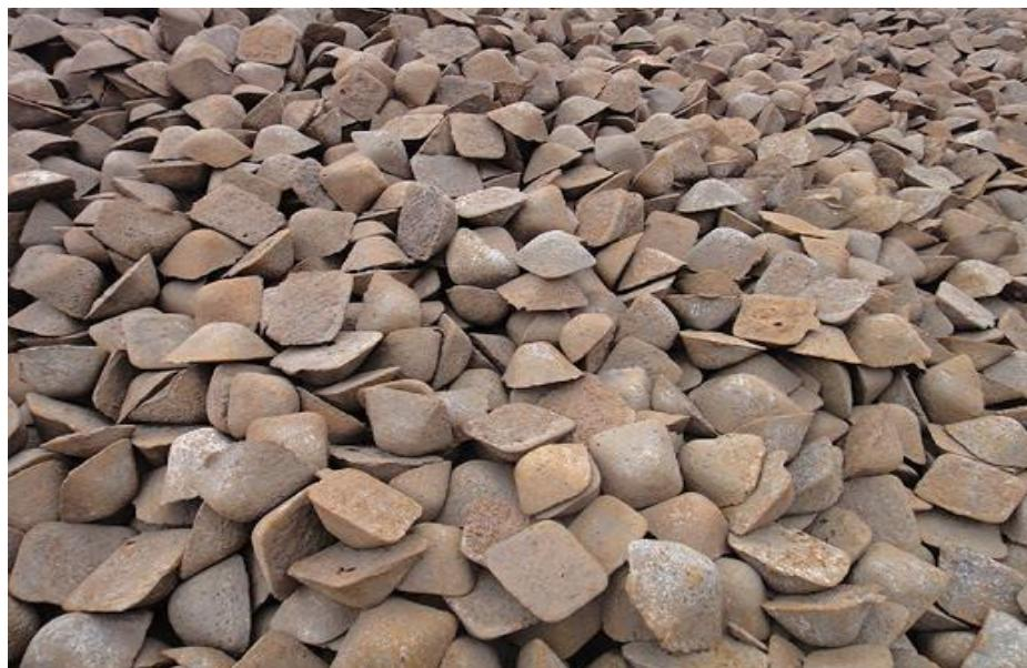
Slika 13. Sirovo željezo koje se ulaže u kupolnu peć [17]
