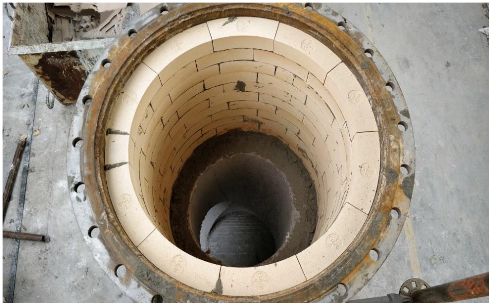
Slika 7. Primjer ozida peći [13]
