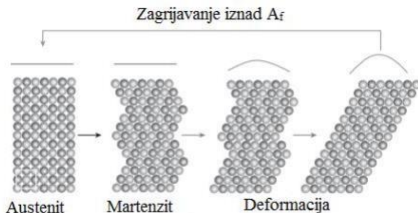
Slika 3. Mehanizam efekta prisjetljivosti oblika [12]
