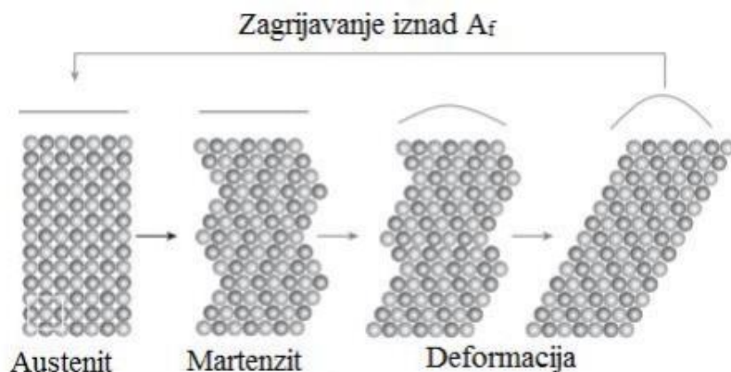
Slika 3. Mehanizam efekta prisjetljivosti oblika [12]
