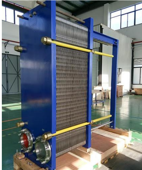
Slika 3. Pločasti izmjenjivač topline [7]
