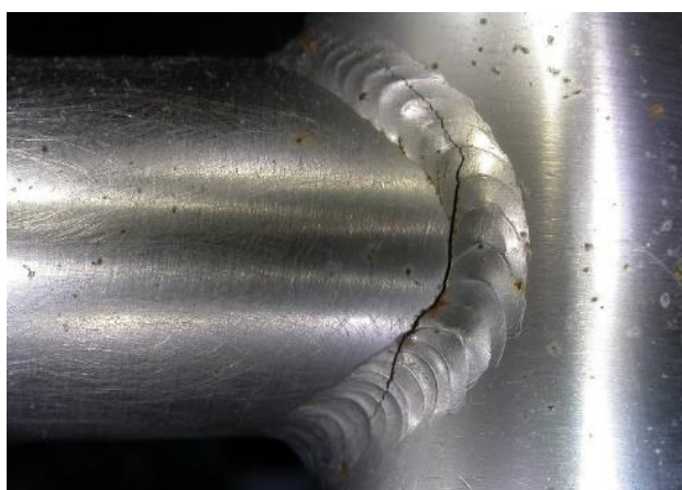
Slika 5. Pukotina zavarenog spoja [19]
