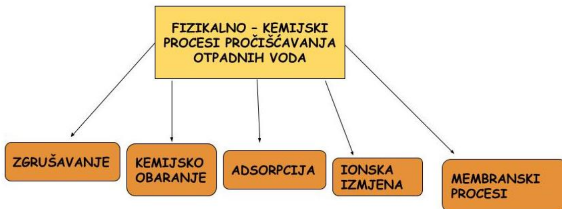
Slika 10. Fizikalno – kemijski procesi pročišćavanja otpadnih voda
