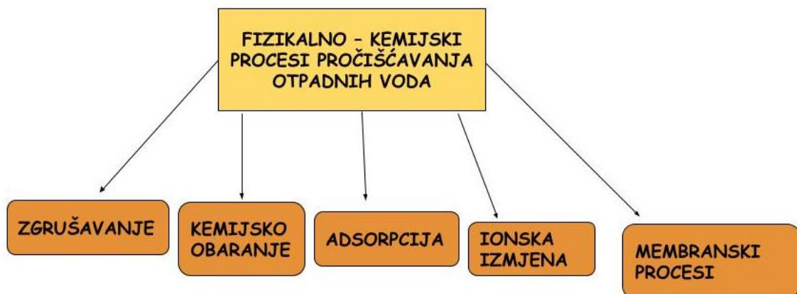
Slika 10. Fizikalno – kemijski procesi pročišćavanja otpadnih voda
