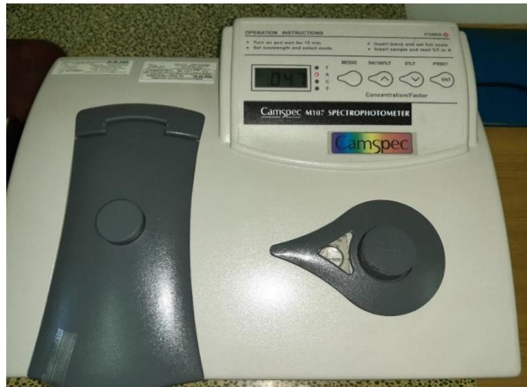
Slika 7. UV-VIS spektrometar
