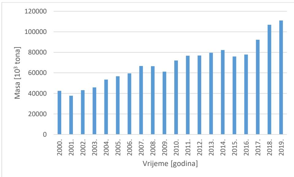
Slika 26. Grafički prikaz proizvodnje direktno reduciranog željeza u svijetu
