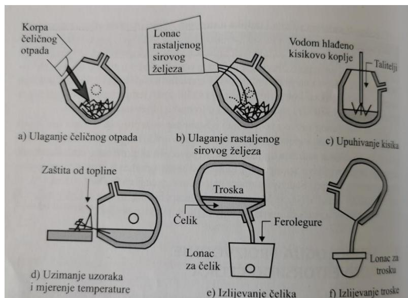
Slika 9. Tehnološki prikaz proizvodnje čelika u kisikovom konvertoru [2]
