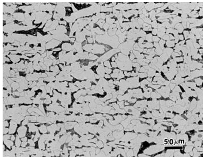
Slika 3. Mikrostruktura feritnog čelika s određenim udjelom perlita [13]
