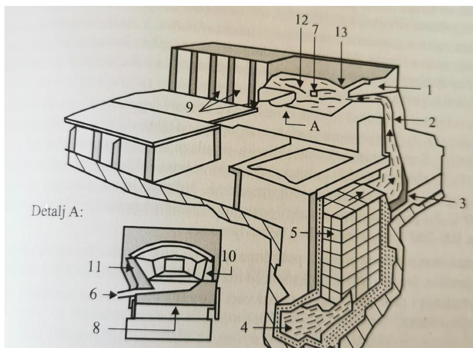
Slika 8. Shematski prikaz SM peći s reakcijskom komorom [2]
