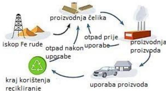
Slika 5. Proces recikliranja čelika [18]
