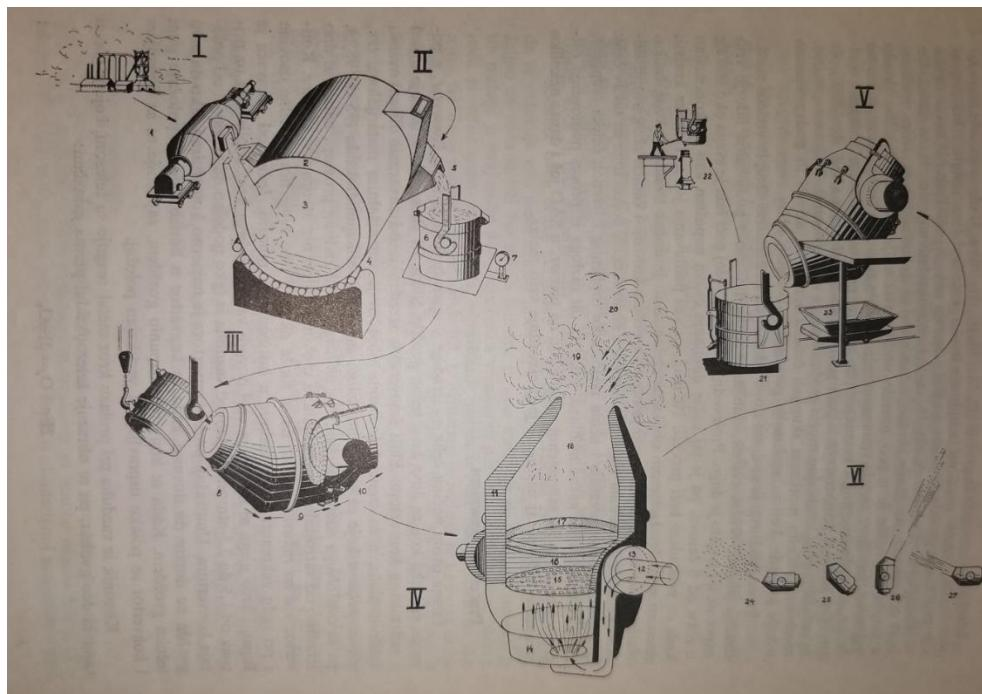
Slika 7. Tehnološki postupak proizvodnje čelika u Bessemerovom konvertoru [23]
