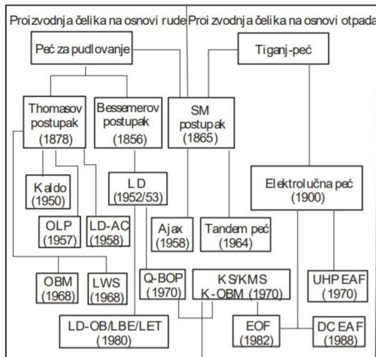
Slika 6. Shematski prikaz proizvodnje čelika kroz povijest [21]
