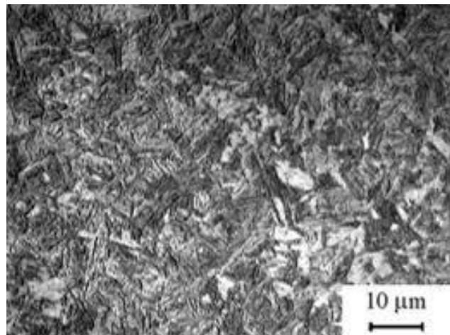
Slika 2. Mikrostruktura martenzitnog čelika [12]
